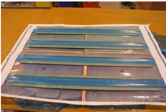
Abb.16: Aufrüstung der Schlauchkerne und der Blisterfolie
