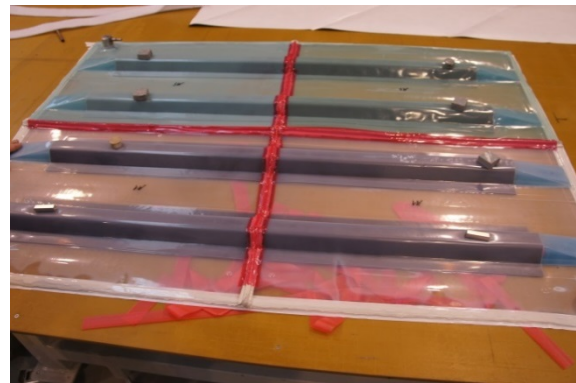
Abb.16: Aufrüstung der Schlauchkerne und der Blisterfolie
