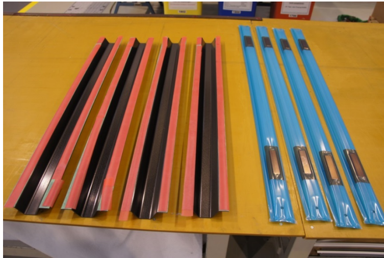
Abb.15: Stringer mit Klebefilm FM300 und Schlauchkerne
