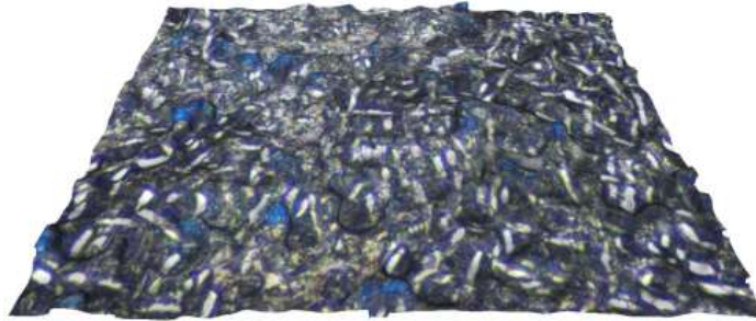
Abbildung 1.4.1.3: Oberfläche nach BEA, mit Resten der Anodisierschicht (blau)
