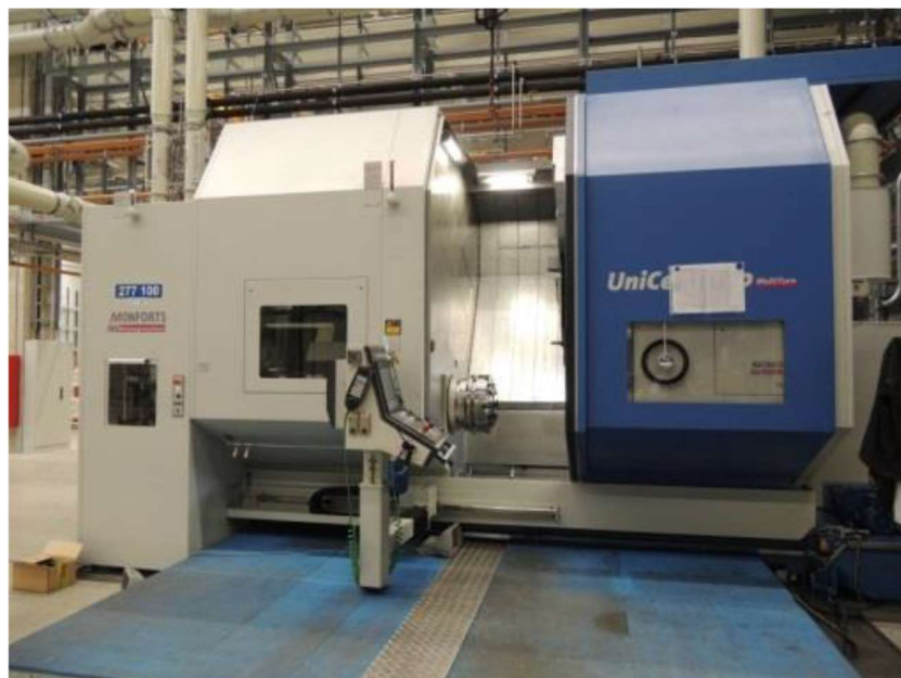
Abbildung 1.4.3.3: Serienmaschine Monforts Unicen 1000 in der Rotorfertigung MTU München
