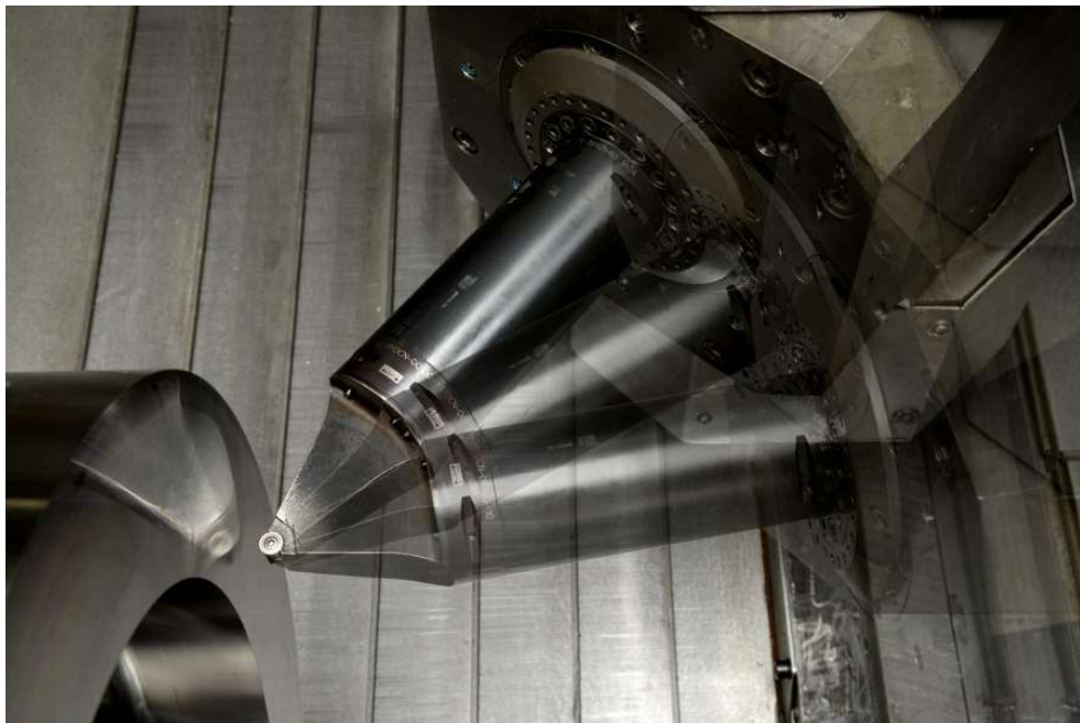
Abbildung 1.4.3.2: Drehbearbeitung mit aktiver B-Achse (Überlagerungsbild)
