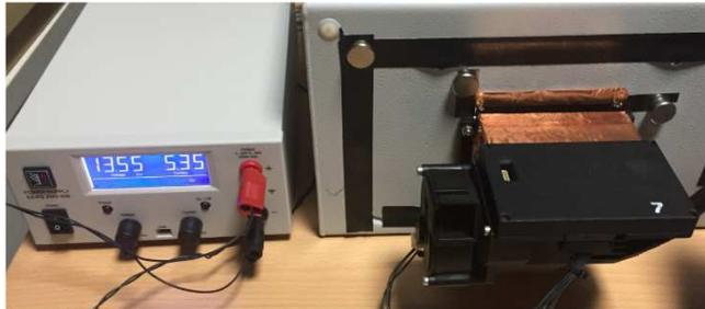
**Abbildung A7** Lebensdauertest nach ca. 1250h Laser-Dauerbetrieb (wird fortgeführt)
