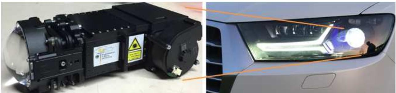
**Abbildung K1:** LINKS: Komplettes iLaS-Modul, wobei die Abmessungen durch den nutzbaren Bauraum im Zielscheinwerfer bedingt sind. RECHTS: Die realisierte Integration des iLaS-Moduls im Versuchsfahrzeug Audi Q7.
