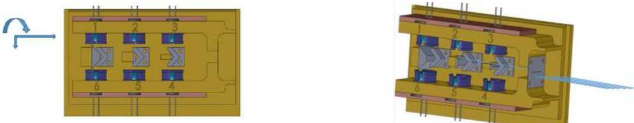
**Abbildung J2:** Justage-Strategie mit den drei relevanten Freiheitsgraden der 6 LD-Submounts und Justage-Ziel von sechs zueinander exakt ausgerichteten Strahlbündeln im Beamcombiner
