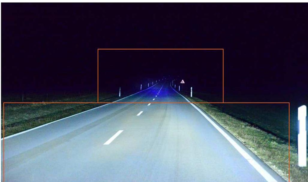
**Abbildung A8:** Impressionen einer Nachtfahrt mit dem zentralen Bereich des Laser-Scanners für das adaptive Fernlicht (oberer Kasten; hier ohne LED-Matrix) und der Vorfeldbeleuchtung mit LED-Grundlicht (unterer Kasten); Farbort des Converter-Batches ist bewusst blau gewählt
