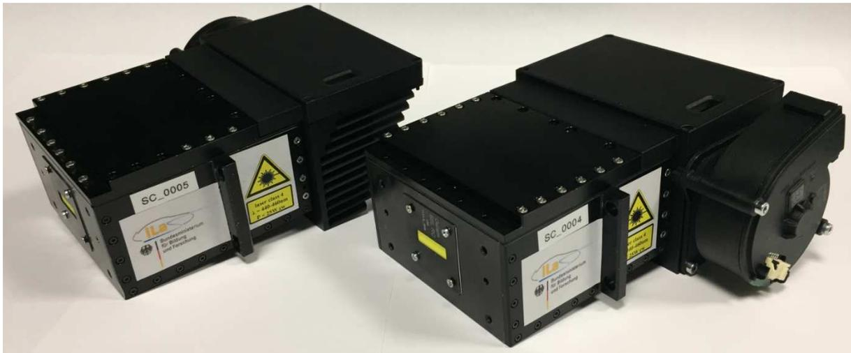
**Abbildung A1:** Zwei iLaS-Prototypen bestehend aus Scanner-Einheit und Systemelektronik sowie Kühlkörper und Lüfter.
