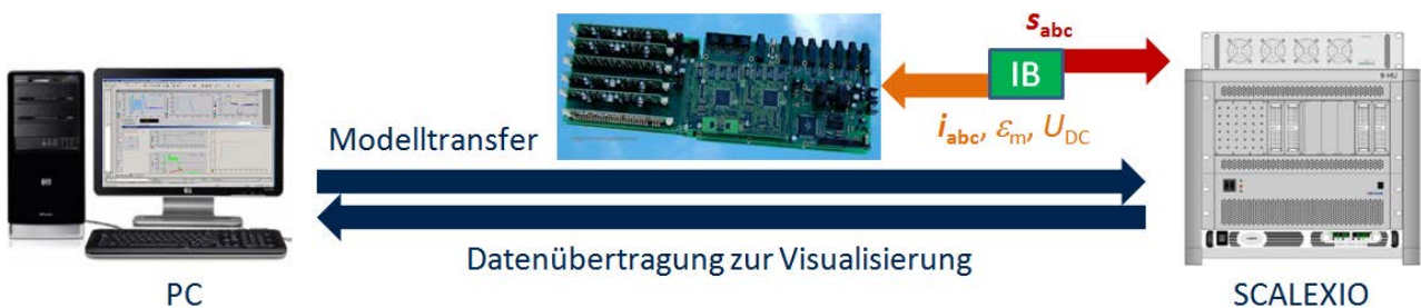
Abbildung 2.3.1: Testaufbau, bestehend aus ServoOne-Board, Interface-Board (IB), Scalexio (HIL) und einem PC
