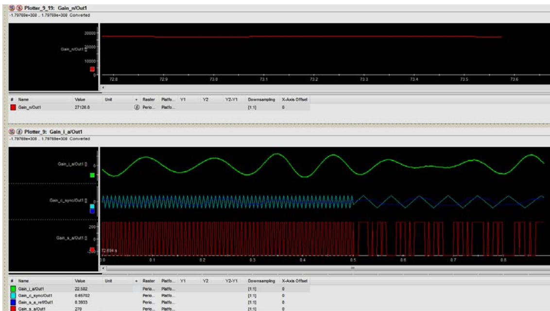
Abbildung 2.3.3: Graphische Oberfläche der Visualisierungssoftware ControlDesk mit dem Verlauf relevanter Daten aus dem Scalexio und einem harten Umschaltvorgang von STPWM auf SOPWM im stationären Zustand
