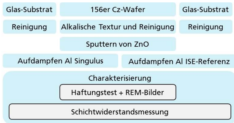
Abbildung 72 Prozesse zur Substratvorbereitung, Al-Abscheidung und Schichtcharakterisierung
