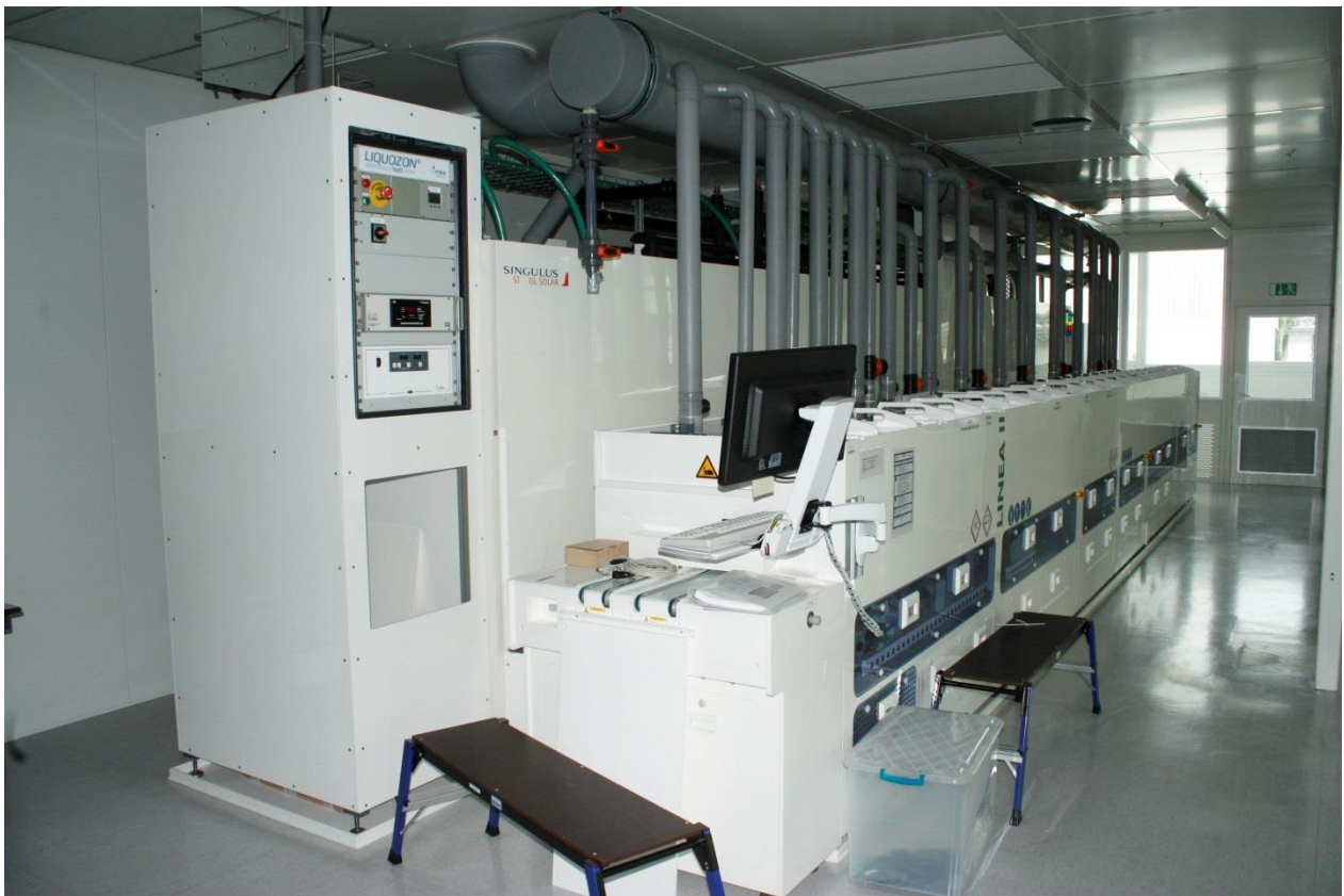
Abbildung 130 LINEA Nasschemieanlage mit Ozongenerator im neuen PVTEC-Select-Labor.
