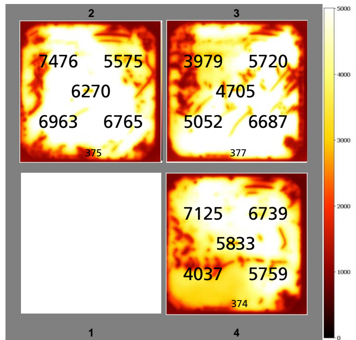
Abbildung 65 \tau_{\text{eff}} Werte und PL Aufnahmen der Proben nach Annealing, PS4: 750W, 480sccm SiH 4 , 420sccm H 2 , Proben: Cz Material texturiert
