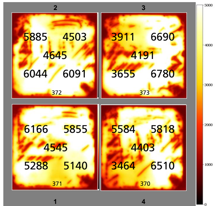
Abbildung 63 \tau_{\text{eff}} Werte und PL Aufnahmen der Proben nach Annealing, PS4: 750W, 500sccm SiH 4 , 500sccm H 2 , Proben: Cz Material texturiert
