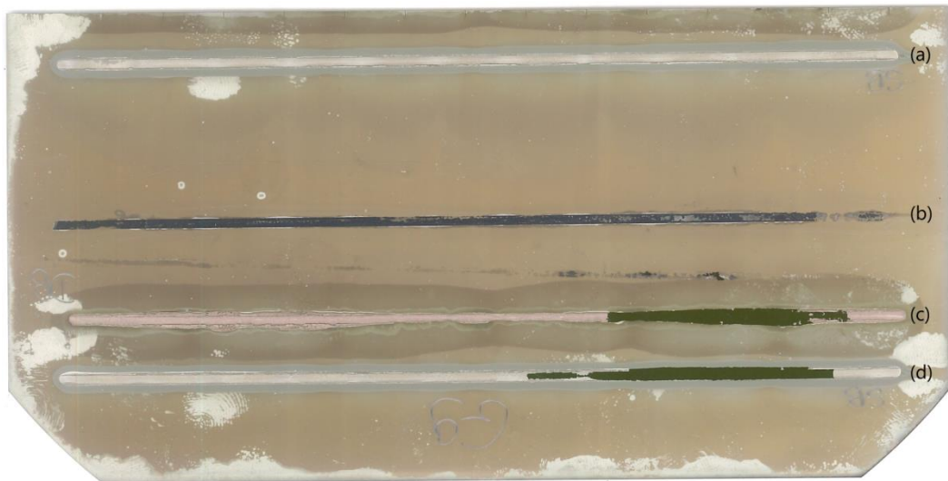
Abbildung 122 Wafer G9 nach Löt- und Klebeversuchen. (a) Klebstoffreste von Kleber B1 nach dem Schältest. (b) Grenzfläche nach dem Abriss des gelöteten Sn 41 Bi 57 Ag 2 Verbinders. Die dunkelgraue Schicht ist vermutlich Silizium. (c) Klebstoffreste von Kleber B1 nach dem Schältest. (d) Klebstoffreste von A1 nach dem Schältest. An den grünen Bereichen ist vermutlich das ZnO freigelegt.
