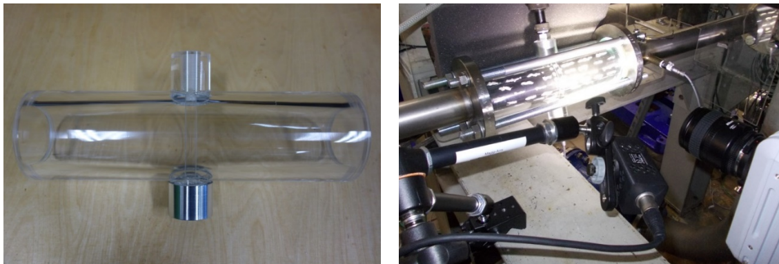
Abbildung 23: Optische Vermessung eines transparenten Pulsationsdämpfers mittels Hochgeschwindigkeitsaufnahmen
