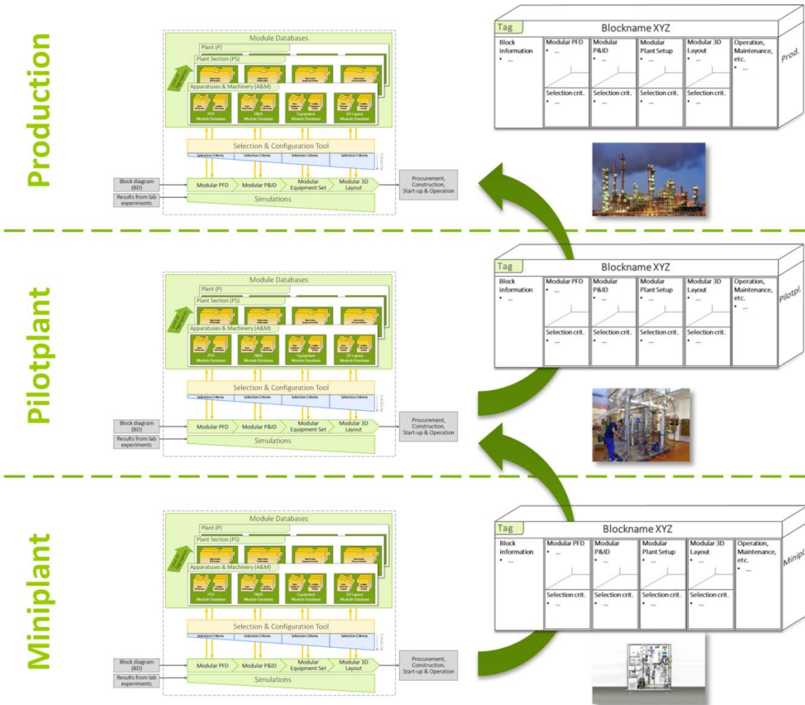
Abbildung 3: Schematische Darstellung der modulbasierten Anlagenplanung auf verschiedenen Realisierungsebenen.
