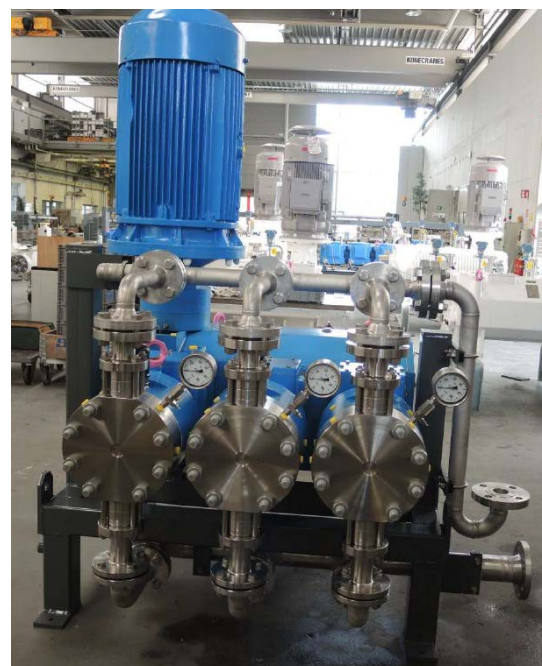
Abbildung 14: Triplex-Membrankolbenpumpe mit standardisierten Anschlüssen und Betriebsbereich (links: schematisch, rechts: Foto)
