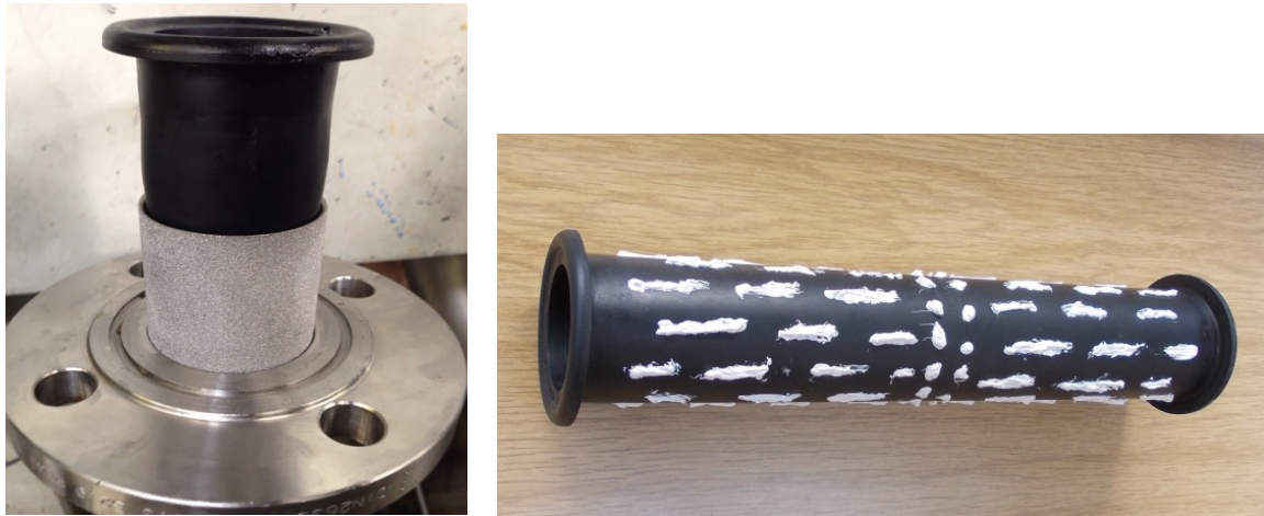
Abbildung 21: Varianten zur Vermeidung des Anlegens der Membran an die Gehäusewand (links: Sintermetalleinsatz, rechts: Noppenstruktur auf Membran)
