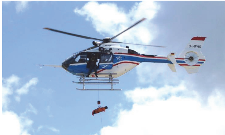
Abbildung 6-41 : ACT/FHS mit Außenlast im Flugversuch (Mai 2015)
