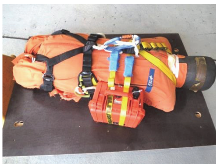
Abbildung 6-42 : iMAR-Messkoffer mit IMU und GPS am Lastkörper
