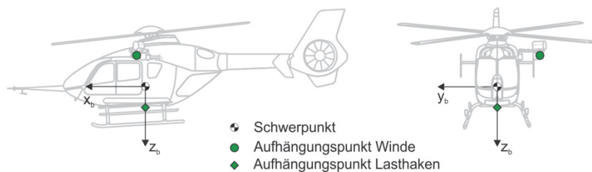
Abbildung 6-67 : Aufhängungsposition bei der Winde und beim Lasthaken
