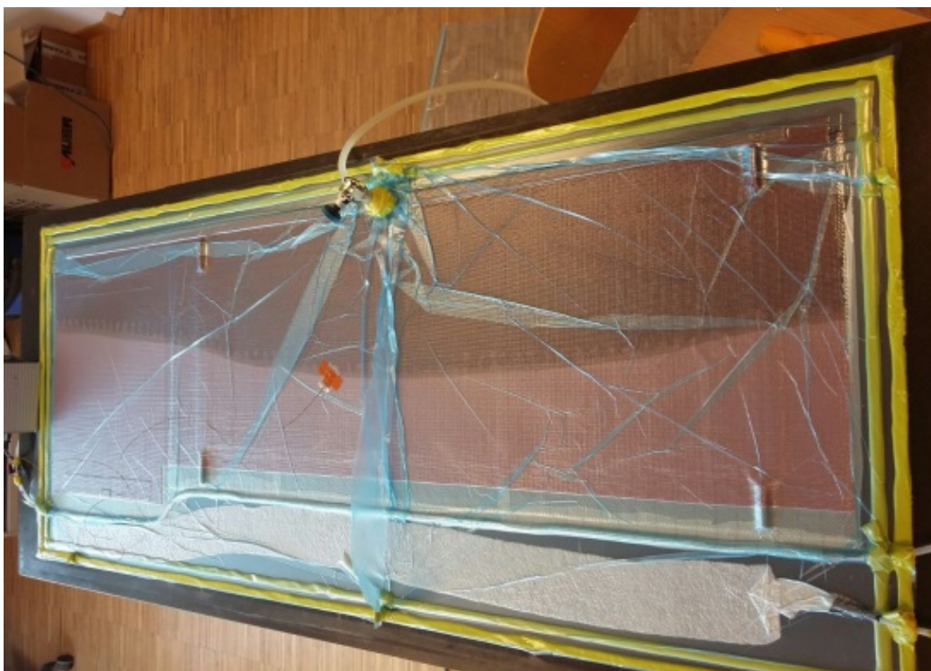
Abbildung 39 Infusion einer Probeplatte für Zyklustests [4]
