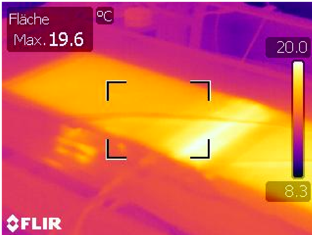
Abbildung 37: Infrarotbild des Überlappungsberreiches im Vorversuch unter Vakuum, deutlich ist noch die heißere Überlappung zu erkennen die optimiert wurde [4]
