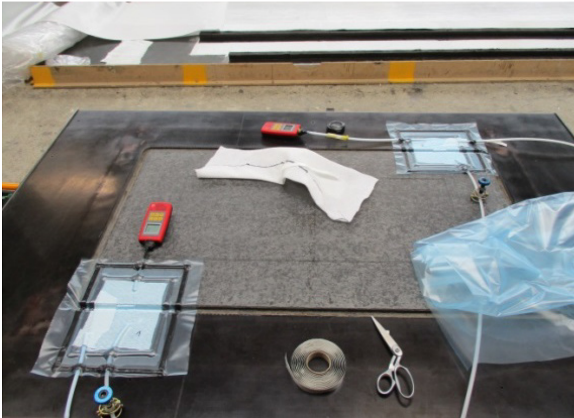
Abbildung 51: vakuumtest der Anschlüsse im umlaufenden Kanal [4]
