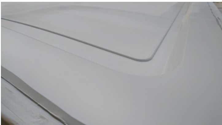
Abbildung 54: Detailansicht des Vakuumkanals im negativ [4]
