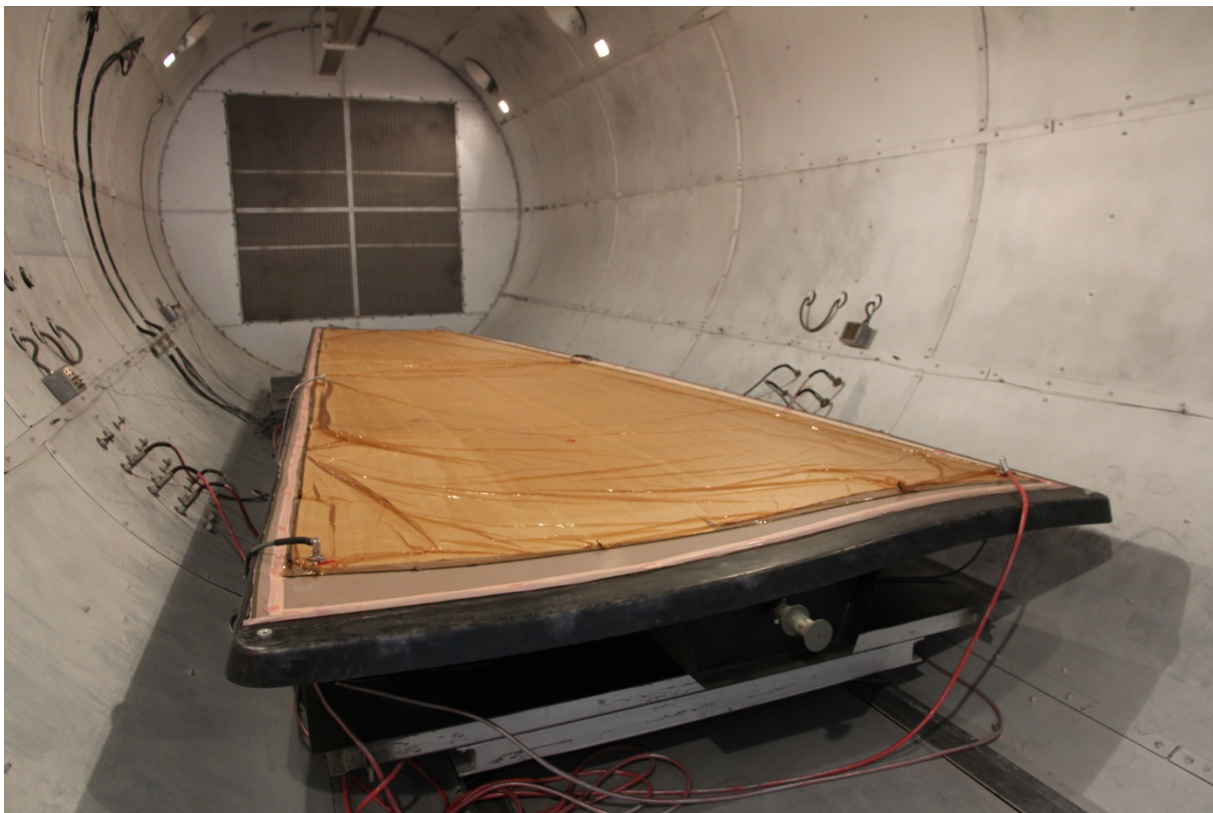
Abbildung 4: Demonstrator-Werkzeug im Autoklaven des DLR [2]
