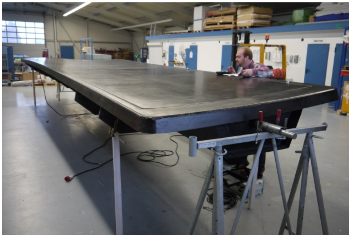
Abbildung 60: Abnahme des fertigen Werkzeuges vor der Auslieferung [4]
