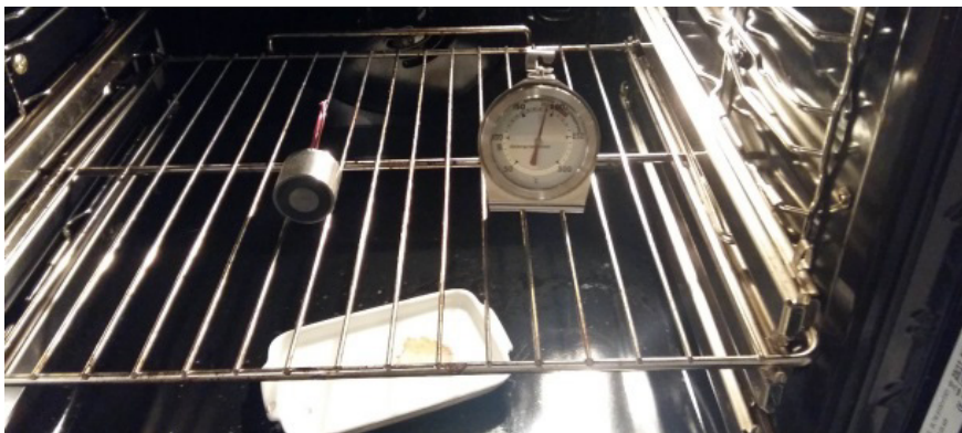
Abbildung 32: Temperaturbeständigkeitstest der Magnete, die Zertifizierung reichte nur bis 150°C [4]
