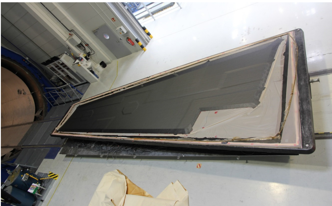
Abbildung 71: Werkzeug und Bauteil nach Autoklavgang [2]
