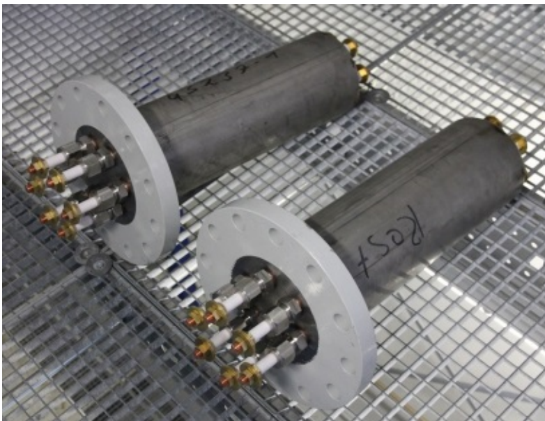
Abbildung 68: Schottdurchführungen für die elektrische Last [3]
