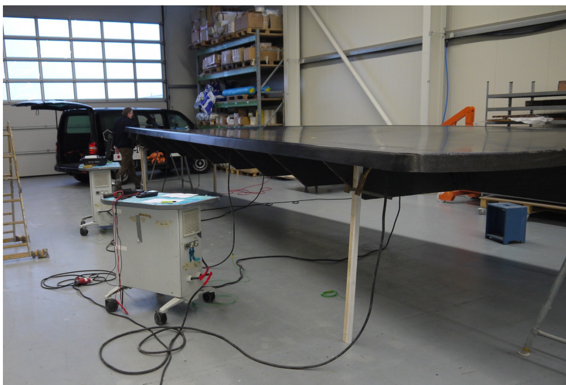
Abbildung 61: Heizungstest mit mobilen 8kVA Netzgeräten [4]
