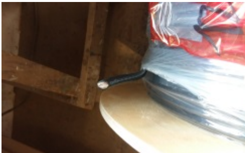
Abbildung 30: Speziell angefertigtes hochtemperaturkabel mit silikonfreier Teflonumantelung [4]
