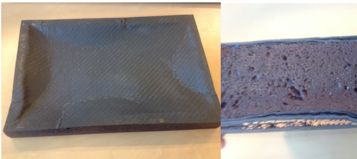
Abbildung 38 a & b: Couponstest zur Druckstabilität des Wabenkerns im Autoklaven [4]
