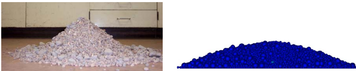
Bild 54: Schüttwinkelversuch, links am realen Material, rechts DEM-Simulation
