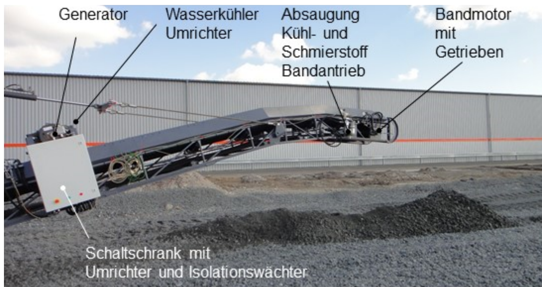
Bild 165: Elektrischer Bandantrieb auf Versuchsgelände in Windhagen
