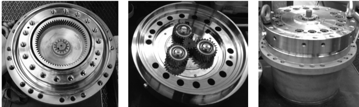
Bild 152: Montierter Hinterrad prototypenantrieb (links: Tragachse mit Hohlradscheibe; mitte: High Speed Planetenträger, rechts: fertig montiertes Hinterradgetriebe)
