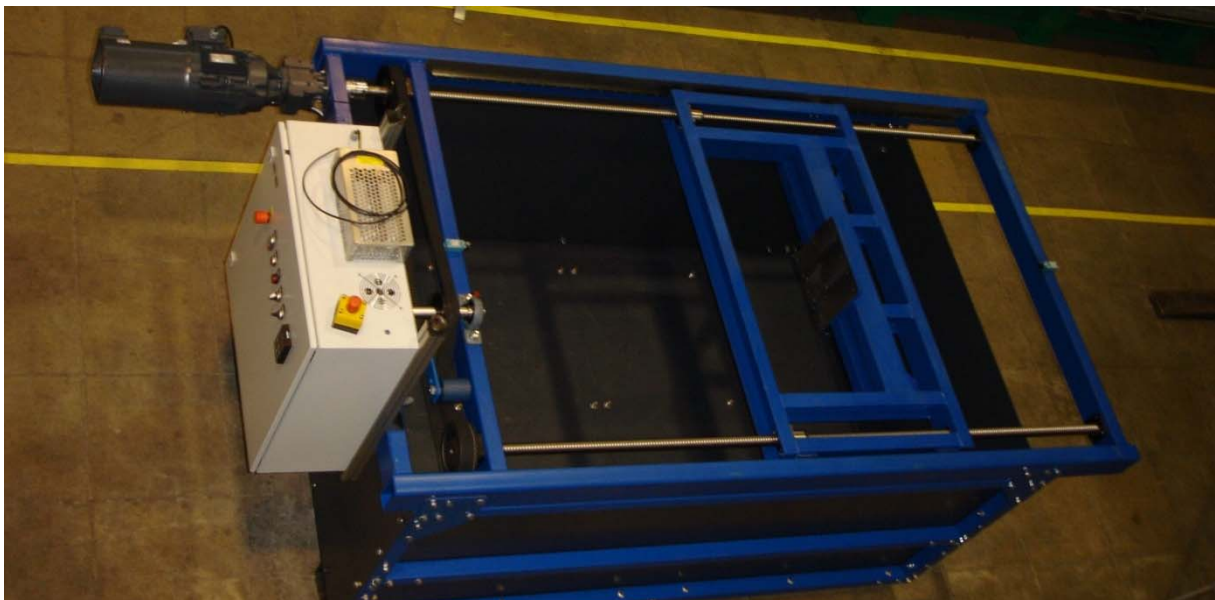
Bild 76: Prüfstand zur Kalibrierung von DEM-Modellen
