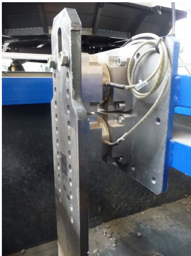
Bild 77: Kraftmesssystem bestehend aus zwei Piezokraftaufnehmern
