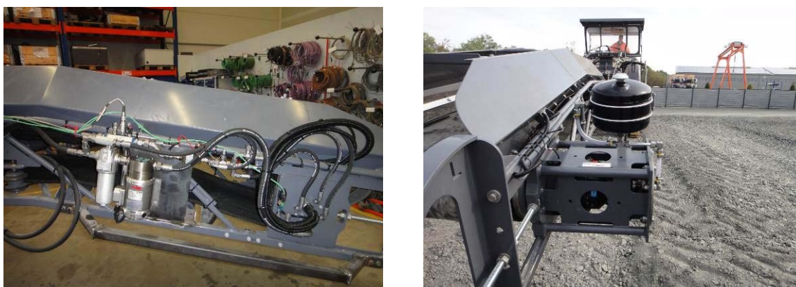
Bild 167: Absaugpumpe und Getriebe mit Ausgleichsbehälter
