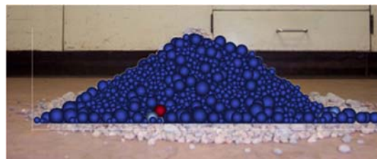
Bild 56: Vergleich zwischen Messung und Simulation eines Schüttwinkelvesuches mit dem implementierten Rollreibmodell Typ C
