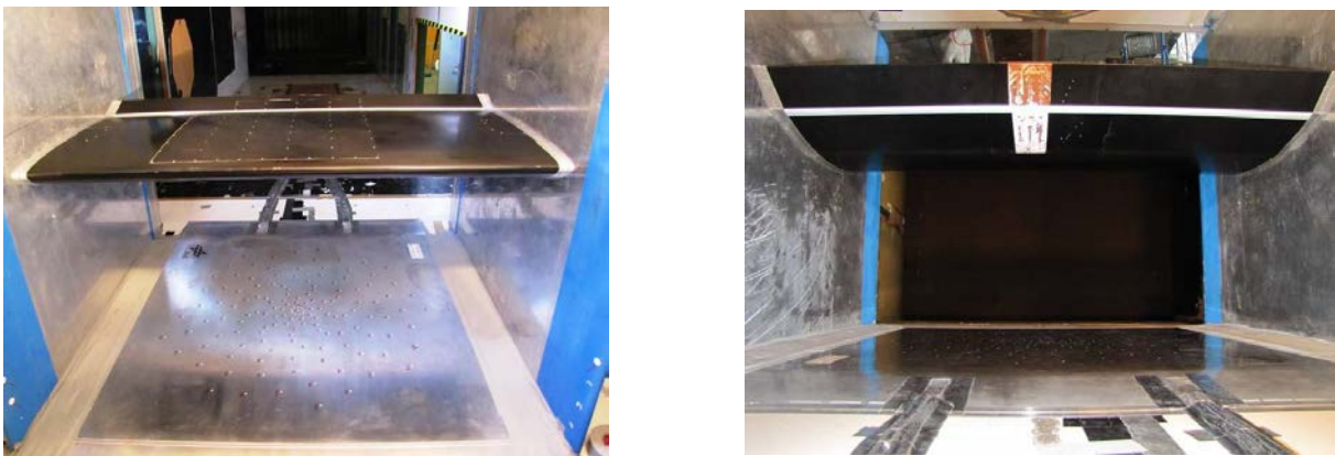
Abbildung 4: Fotos des Messaufbaus. Das 2D-Profil ist in der Mitte des Kanals mit der Saugseite nach unten ausgerichtet und das Mikrofonarray befindet sich auf dem Boden. Links: Blick in Strömungsrichtung, Rechts: Blick aus Strömungsrichtung, mit der kupferfarbenen Fläche ist die Lage der OHDs auf dem Profil und der Klappe zu sehen.
