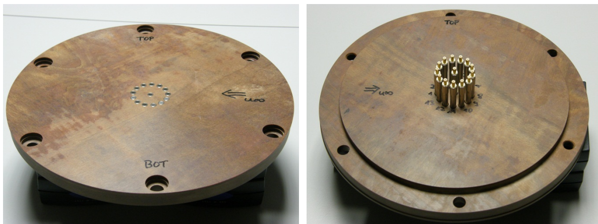
Abbildung 30: Fotos des gefertigten Blindfensters aus OBO-Festholz mit den 14 Mikrofonen. Links ist die der Messstreckenseite zugewandte Seite zu sehen, rechts die Rückseite. Die Membrane der Kryokondensatormikrofone sind wandbündig ausgerichtet.
