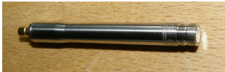
Abbildung 11: Foto eines Kondensatormikrofons für die Anwendung in kryogener Umgebung. Am rechten Ende ist die Mikrofonmembran zu erkennen.
