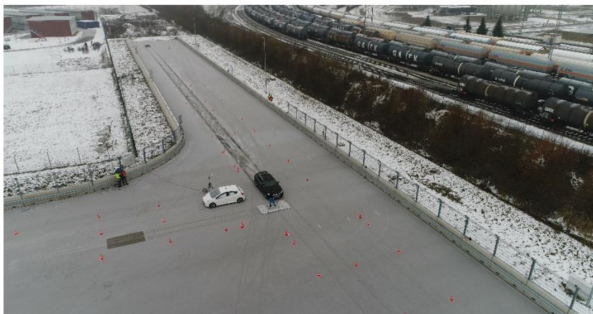
Abbildung 11: Kritische Verkehrssituation mittels Attrappen auf dem CARISSMA-Freiversuchsgelände
