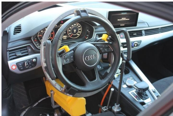
Abbildung 10: Fahrzeug mit montiertem Fahrroboter
