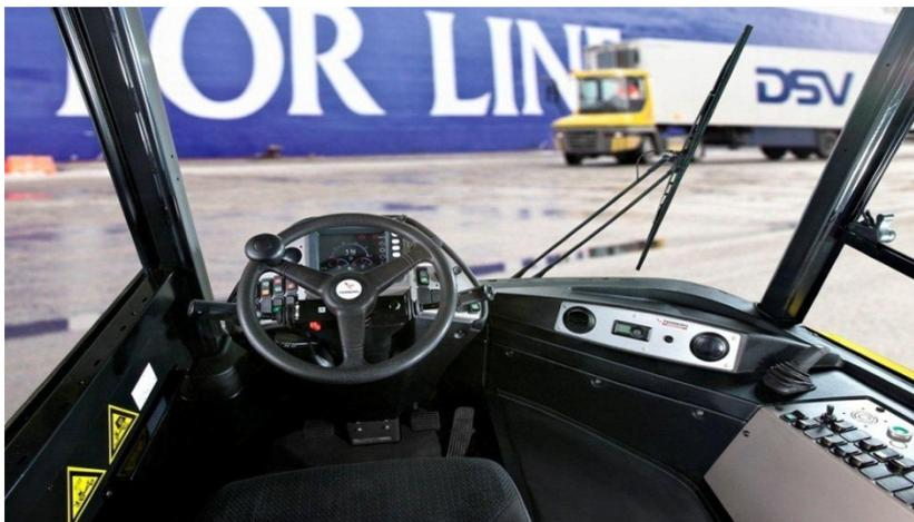
Als besonders wichtig wird ein luftgefederter Fahrersitz angesehen, der in der Lage ist das Fahrergewicht selbstständig auszugleichen. Weiterhin müssen eine ausreichende Beheizung, sowie eine Klimaanlage vorhanden sein. Die Kapazität der Heizung ist so auszulegen, dass bei 0° C Außentemperatur innerhalb von acht Minuten eine Innentemperatur von 20 ° C erreicht werden muss und auch bei Leerlauf des Fahrzeugs gehalten werden.
