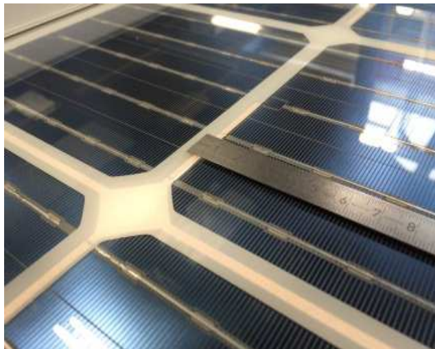
Abbildung 29 Optisches Modul in B-Qualität aufgrund verschobener Matrix
