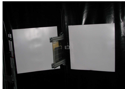
Abbildung 6 Konzept und Realisierung eines Versuchsaufbau für einen bifacialen Flasher
