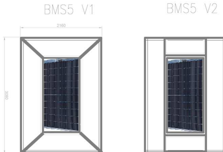
Abbildung 3 Konstruktive Lösungen für Dauerlicht Sonnensimulator
