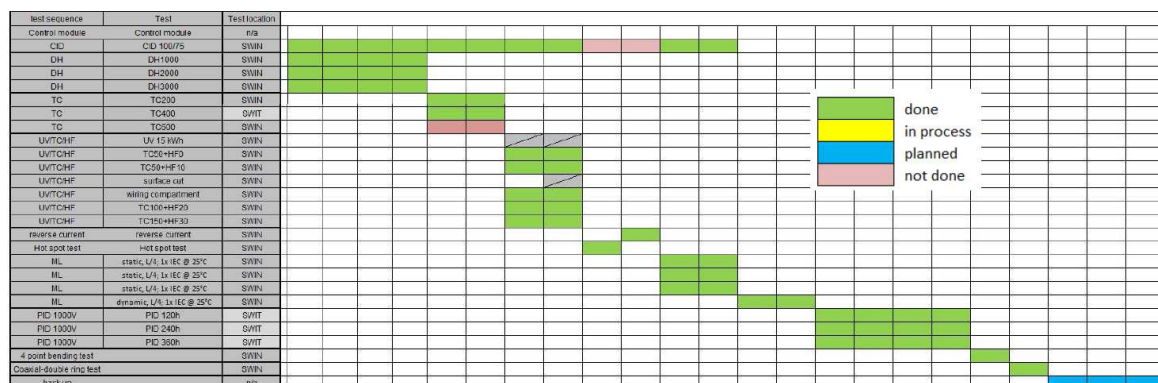
Abbildung 21 Prüfplan und Prüfergebnis für die Qualifizierung bedruckter Rückseiten Gläser
