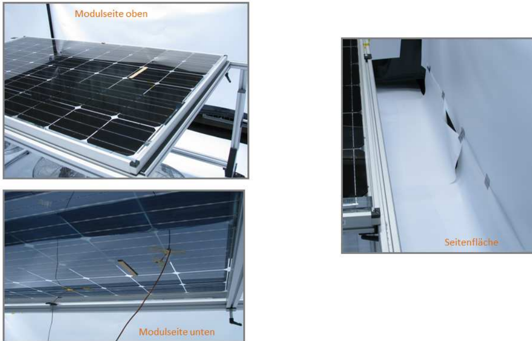
Abbildung 5 Versuchsaufbau für beidseitige Beleuchtung im Dauerlicht Sonnensimulator, links oben: Modulvorderseite, links unten: Modulrückseite mit Temperatursensoren, rechts: mit reflektiver Folie (weiß) ausgekleidete Umhausung
