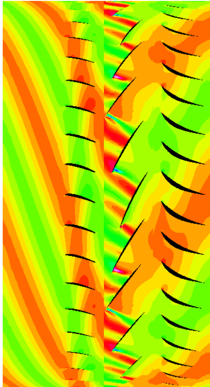
Abbildung 4: Rekonstruktion der Mehrreihenrechnung mit dem Gitter aus Abbildung 2. Simulation mit einlaufender Störung am Eintritt und vorgegebener Rotorschaukelbewegung.
