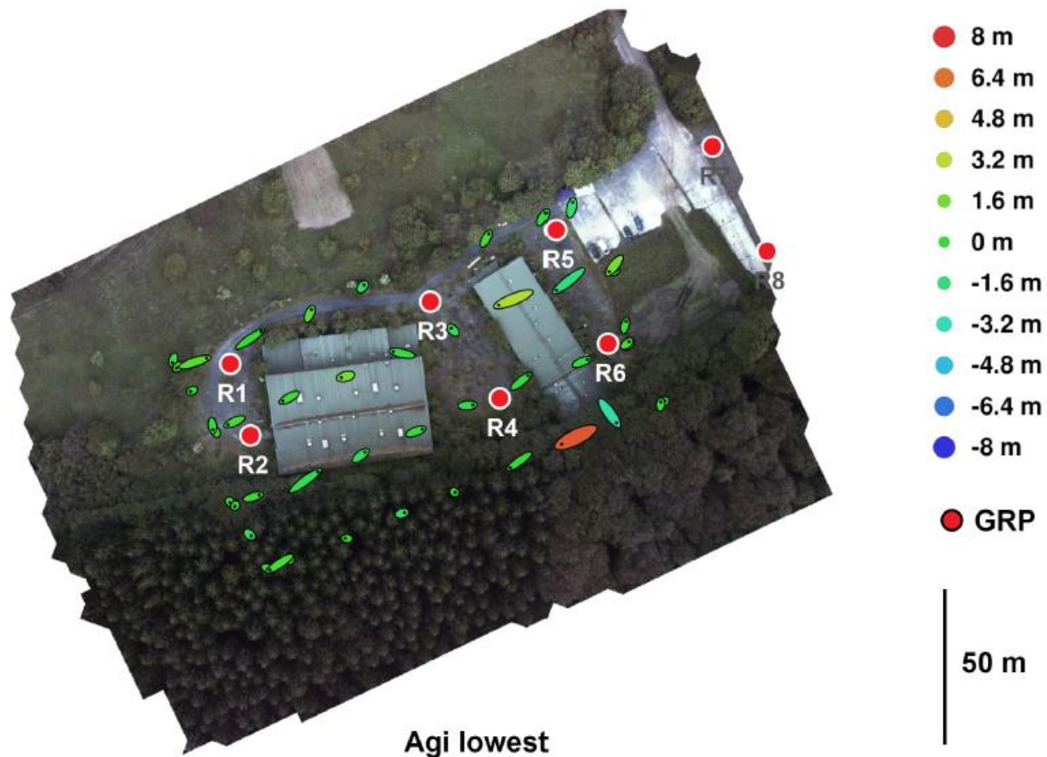
Abbildung 6-65: Orthophoto mit schnellsten Profil mit Referenzpunkte und Fehler Ausgleichsrechnung
