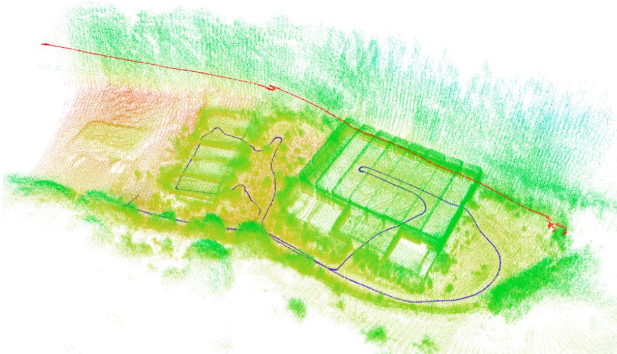
Abbildung 6-72: Zusammengesetzte Karte bestehend aus LiDAR-Scans eines UAVs (rote Trajektorie) und eines UGVs (blaue Trajektorie)
