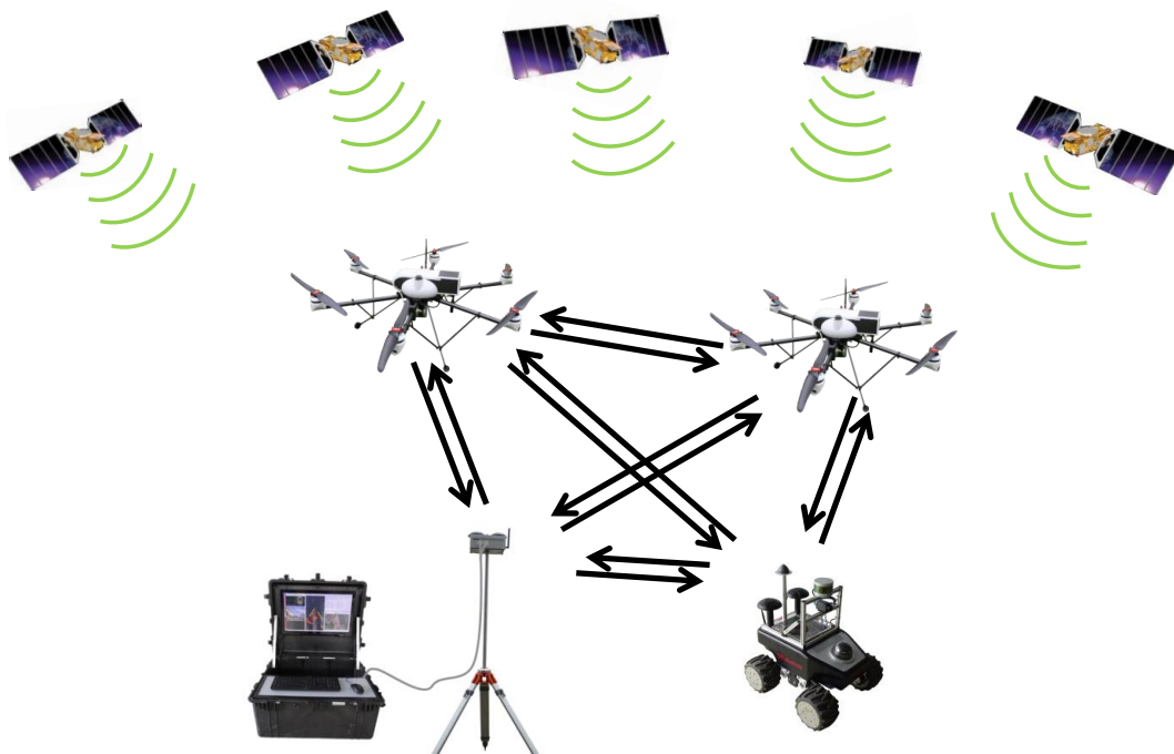
Abbildung 6-16: Prinzip Austausch GPS Messungen im Gesamtsystem
