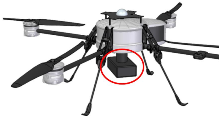
Abbildung 6-31: Flugplattform mit RTK Testaufbau
