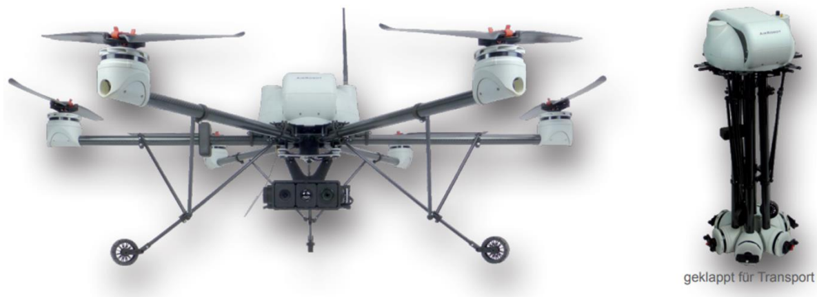
Abbildung 6-92: AR200 aufgebaut (links), AR200 geklappt (rechts)
