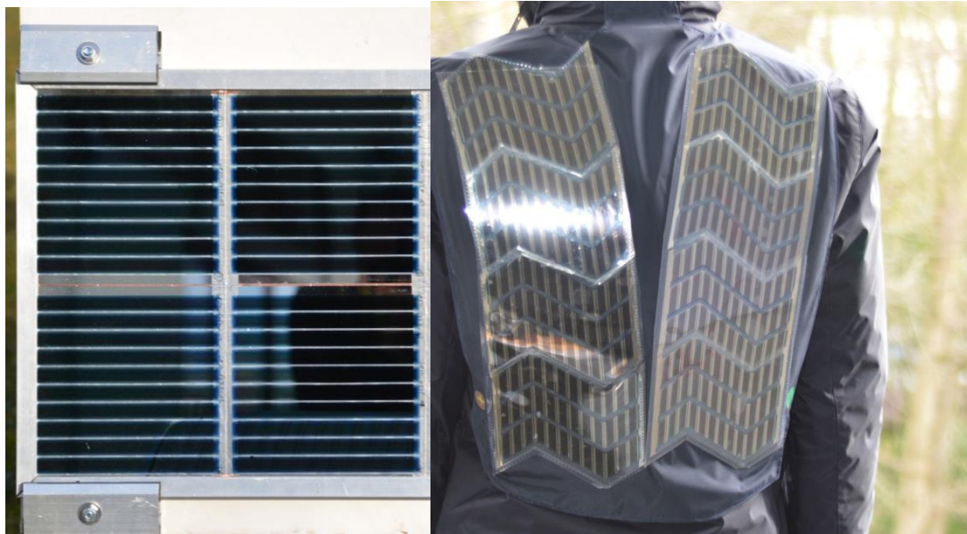
Abb. 37 Integration von auf Glas prozessierten OPV-Modulen in ein Fassadenelement (links) und Integration flexibler OPV-Module in eine Stadionjacke (rechts).
