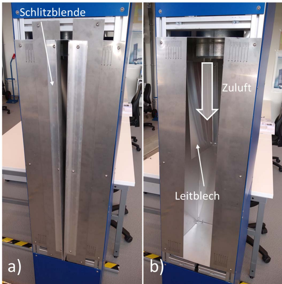
Abbildung 7: Zuluftseite des Portals. a) mit Schlitzblende, b) ohne Schlitzblende
