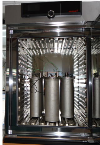
(b) Messmodule im Klima- schrank
