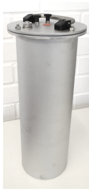
(a) Messmodul (zweite Version) für Lagerung im herkömmlichen AKR-Reaktor
