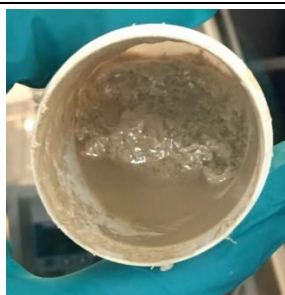
Abb. 12: Schlicker mit alternativem LSP nach einigen Tagen Lagerung. Es ist eine Phasenseparation eingetreten.
