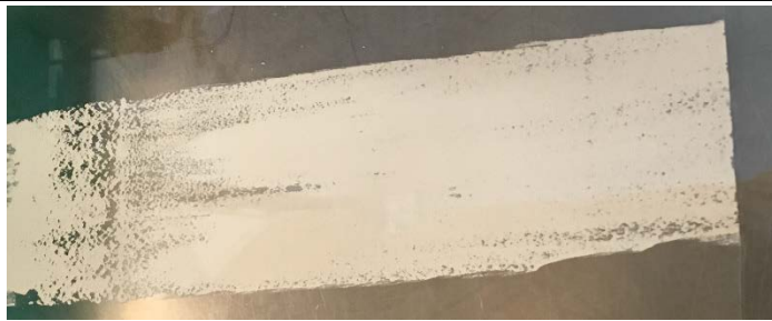
Abb. 11: Gerakelte Schicht mit einem alternativen LPS Pulver.
