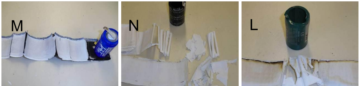
Abb. 6-8: Aufgewickelte Kondensatoren. Separatoren gealterter Kondensatoren. N, M, L identifizieren verschiedene Hersteller.
