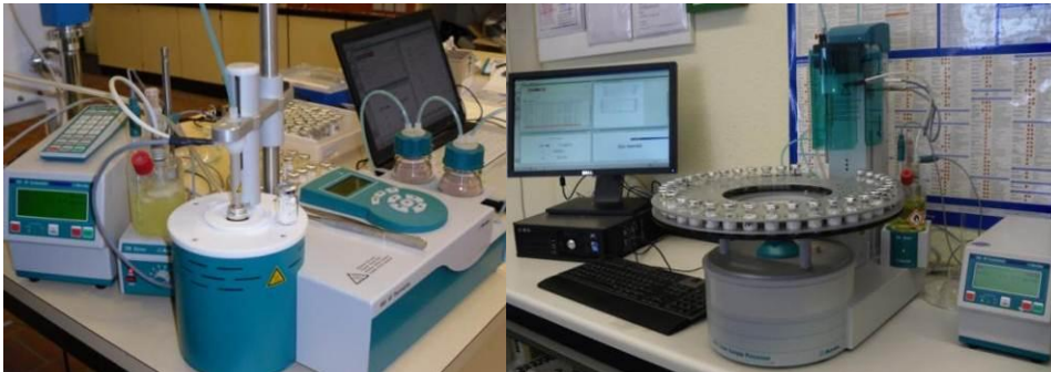
Abb. 4a: Karl-Fischer-Titrationsstand zu Beginn (links) und Abb. 4b: zum Abschluss (rechts) des Projektes.
