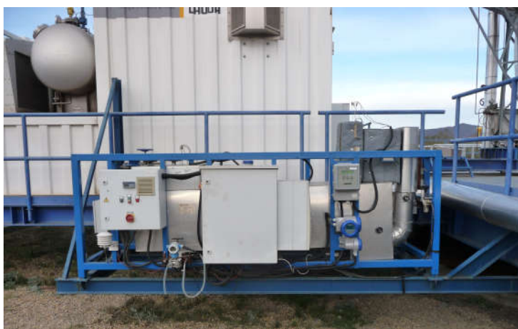
Abbildung 59: Messvorrichtung zur Bestimmung der spezifischen Wärmekapazität von Thermoöl im KONTAS Prüfstand
