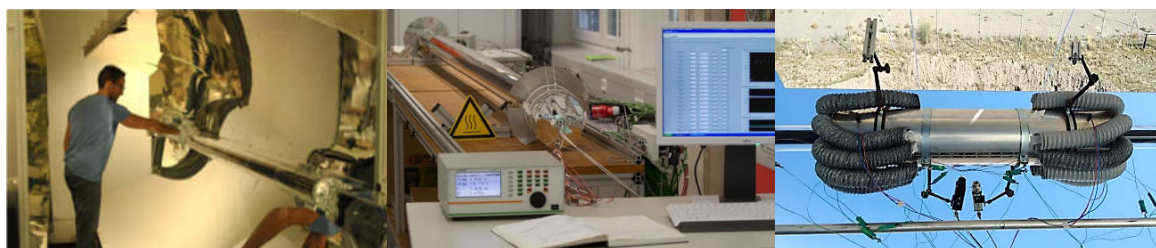
Abbildung 54: Am Ringschluss-Versuch beteiligte Labor- und Feldprüfstände zur Receiverqualifizierung (v.l.n.r.: ElliRec, ThermoRec, PaReSo)
