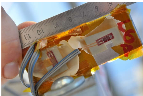
Abbildung 29: Auf den Spiegelmontageklammern installierte Dehnungsmessstreifen (DMS). Die gemessenen Dehnungssignale werden mit den Werten virtueller DMS im Finite-Elemente-Modell verglichen. Rückschlüsse auf Reaktionskräfte auf die Spiegel, welche zu Spiegeldeformationen im laufenden Betrieb führen, werden ermöglicht.
