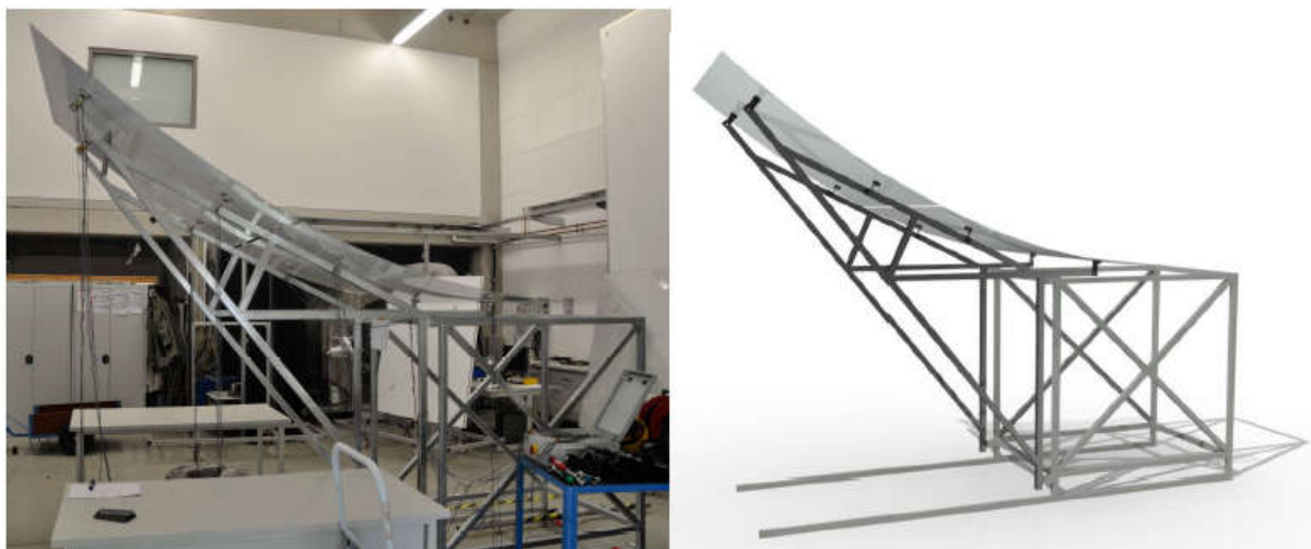
Abbildung 26: Laborstruktur der EuroTrough-Geometrie für Untersuchungen der Einflüsse der Unterstruktur und von Montagefehlern im QUARZ-Labor in Köln. Ein Innen- und ein Außenspiegel können auf original EuroTrough Halteklammern und Kantileverarmen montiert und untersucht werden.
