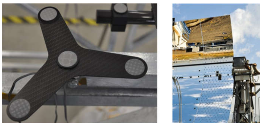
Abbildung 28: (Links) Orientation Measurement Adapter (OMA), die auf den Spiegelmontageklammern montiert werden, um deren Position und Ausrichtung photogrammetrisch zu vermessen. (Rechts) Mit Photogrammetriepunkten präparierte Spiegel in einer Kollektorreihe zur Bestimmung der Durchbiegung der Spiegel in unterschiedlichen Kollektororientierungen. Die Daten wurden mit den Daten einer QFly-Messung zusammengeführt und mit dem Finite-Elemente-Modell verglichen.
