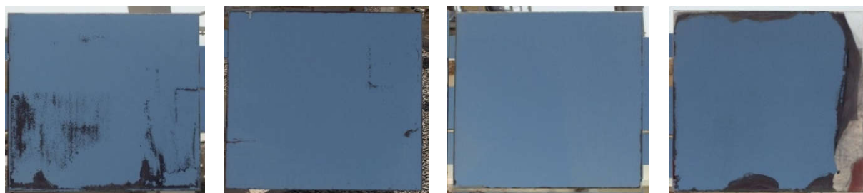
Abbildung 50: Auswahl an Facetten nach sieben Jahren Outdoor-Einsatz
