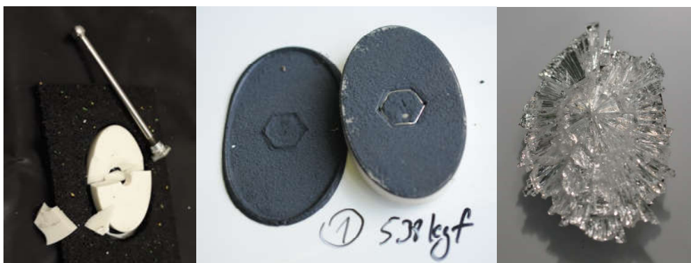
Abbildung 36: Padbruch mit gelöster Gewindehülse am Zugstab (links), Klebestelle und abgezogenes Pad (mitte); abgezogenes Pad mit Glassplittern bei denen der Spiegel gebrochen ist (rechts)
