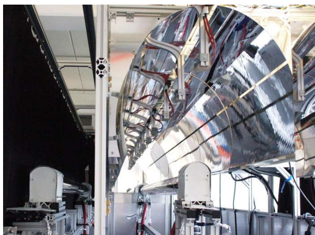
Abbildung 4: OptiRec Prüfstand mit zwei in Testpositionen eingebauten Receivern (links Position A, rechts Position B) die mittels Schiebemechanismus alternierend in der Fokallinie positioniert werden können
