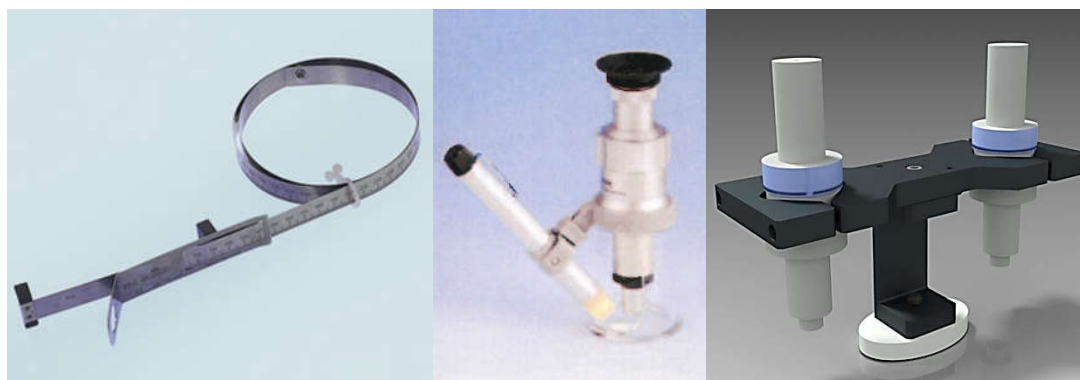
Abbildung 33: Kalibriertes Stahlmaßband mit Anschlägen (links), Standmikroskop mit Lichtquelle (Mitte) [Quelle: Katalog Fa. Gödde], CAD Ansicht des Adapters zur Halterung zweier Mikroskope für Padpositionsmessungen (rechts)
