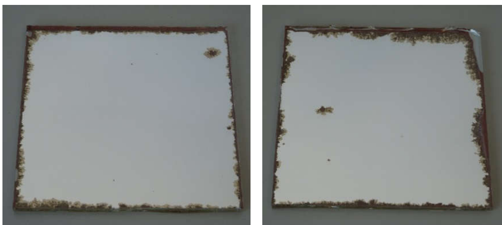
Abbildung 48: Korrosion auf Dickglasspiegel nach 480 h CASS, links mit Abrasion, rechts ohne Abrasion
