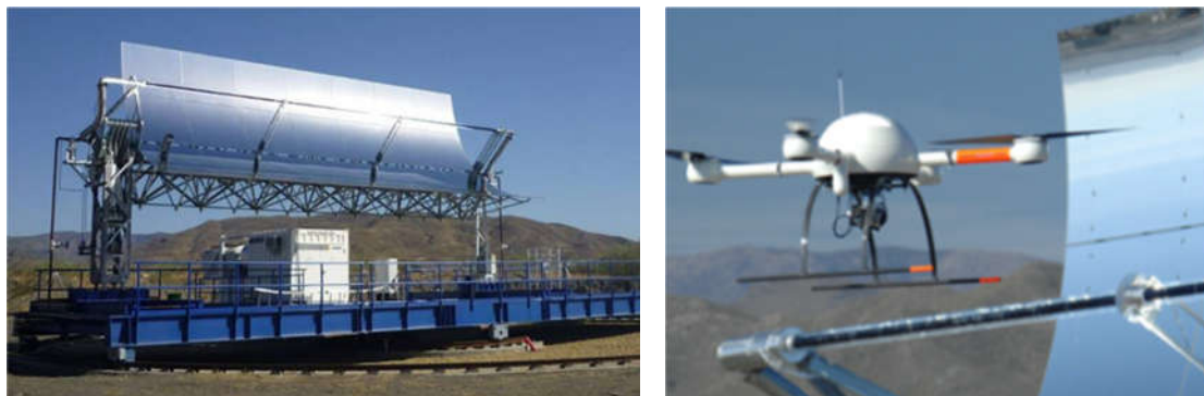
Abbildung 53: Feldtest der Receiver zur thermischen und optischen Qualifizierung im KONTAS-Teststand (links) inklusive QFly-Vermessung (rechts)
