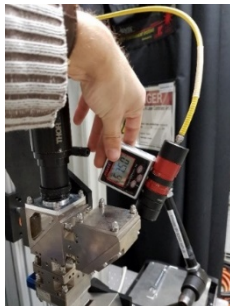
Abbildung 22 T-Stoßkonfiguration mit Nullspalt bei einer Anstellung der Beleuchtung von 47^\circ → Spalt 2 px
