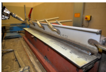
Abbildung 86 Schweißprobe mit sich öffnendem Spalt (Spaltbreite von 0 bis 4 mm, Stoßkonfiguration: T-Stoß mit HP-Profil) oben: ohne Schweißprozess (Beleuchtungsparameter: Stromstärke: 120 A, Pulsdauer: 100 \mu s) unten: mit MAG-Prozess (Beleuchtungsparameter: Stromstärke: 120 A, Pulsdauer: 100 \mu s)
