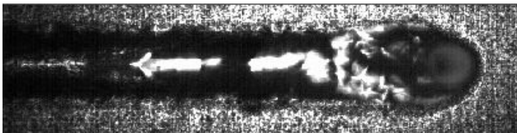
Abbildung 3 Erstarrte und flüssige Schmelze sowie Keyhole mit dem CPC-System während des Schweißprozesses aufgenommen (Draufsicht)
