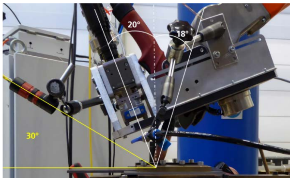
Abbildung 9 Versuchsanordnung laserunterstützter MSG-Prozess
