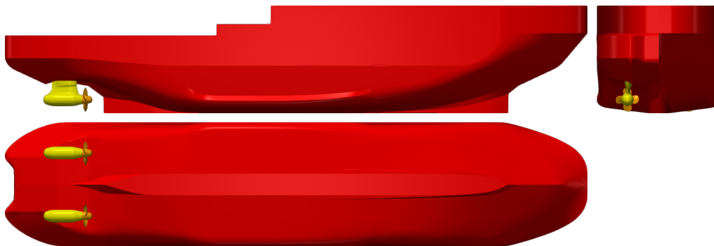
Abbildung 39: Formgebung des mo4977-Schiffsmodells inklusive Pod-Gondeln und Propeller.
