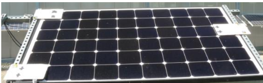
Abbildung 7: Modultest bezüglich Abschattung individueller Zellen im Freiland
