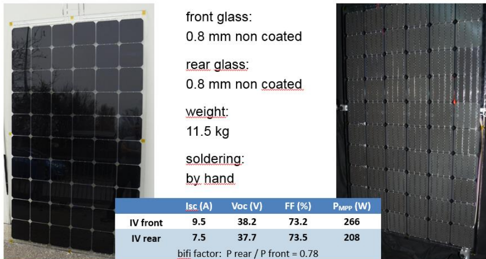
Abbildung 15: ultraleichtes ZEBRA Modul, von Hand gelötet mit Zellen die nur einen niederen Wirkungsgrad aufweisen
