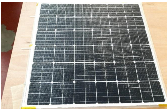
Abbildung 18: ETFE (Vorderseite) - GFK (Rückseite) Laminat mit BiSoNzellen
