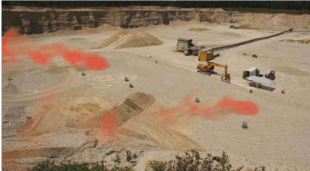
**Abbildung 6.9.5: Experiment zur Gasexploration im Schwarm. Die Ausströmungen der zwei Gasquellen sind als roter Rauch überlagert und ein Wind weht von rechts nach links.**
