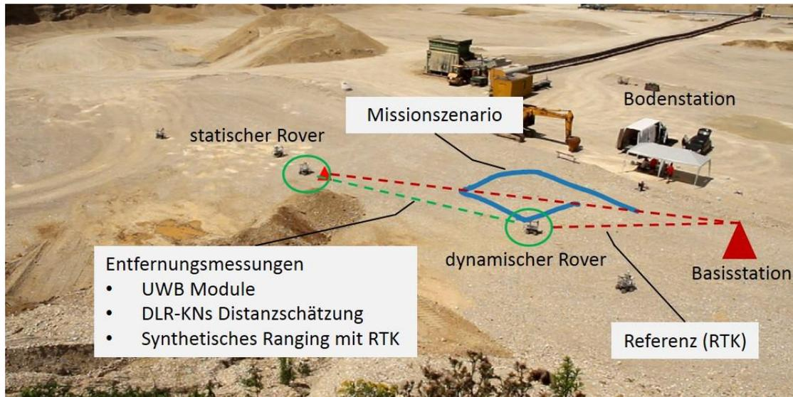
**Abbildung 6.9.8: Experimenteller Messaufbau und geplantes Missionszenario**
