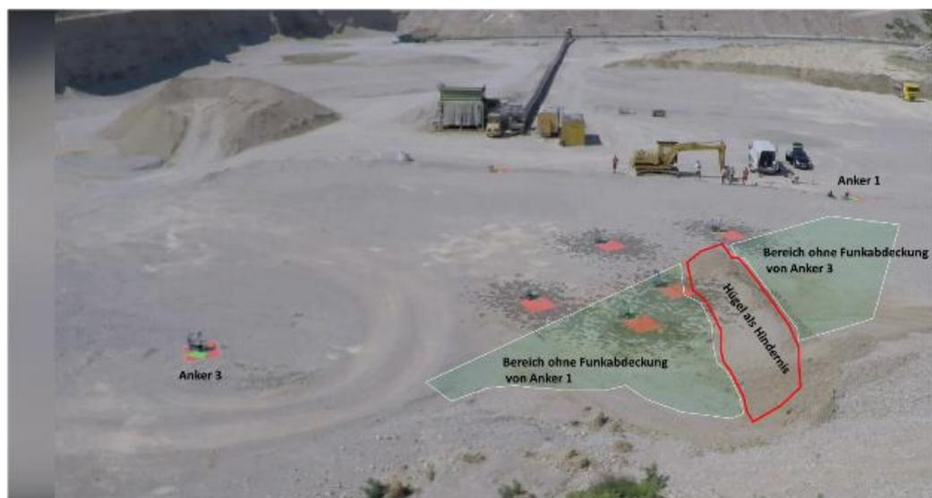
**Abbildung 6.9.4: Zwei Rover befinden sich nun im abgeschatteten Bereich und konnen Anker 1 nicht mehr empfangen. Die Kooperation mit den umgebenden Rovern erlaubt dennoch eine Lokalisierung. Graue Punkte zeigen die Hypothesen des Partikelfilters, rote Rauten die geschatzte Position und grune Dreiecke die tatsachliche Position.**
