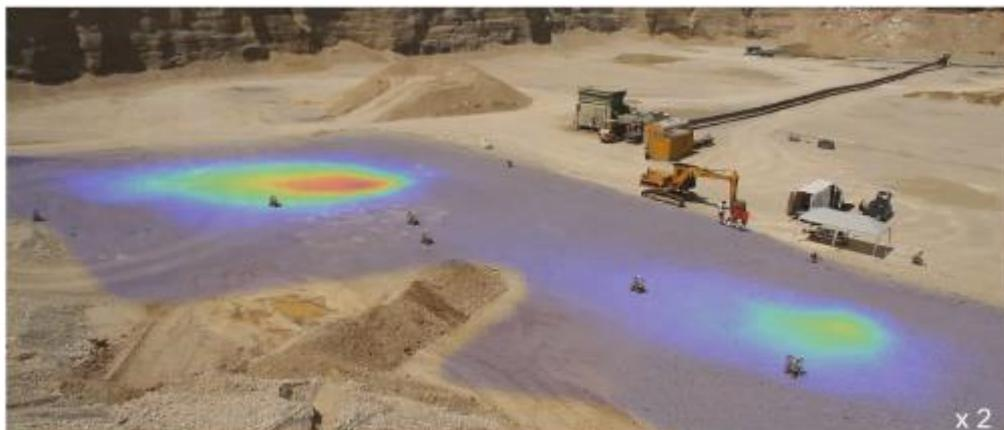
**Abbildung 6.9.6: Beginn der Gasexploration: die tatsächliche Gaskonzentration ist als Überlagerung dargestellt.**
