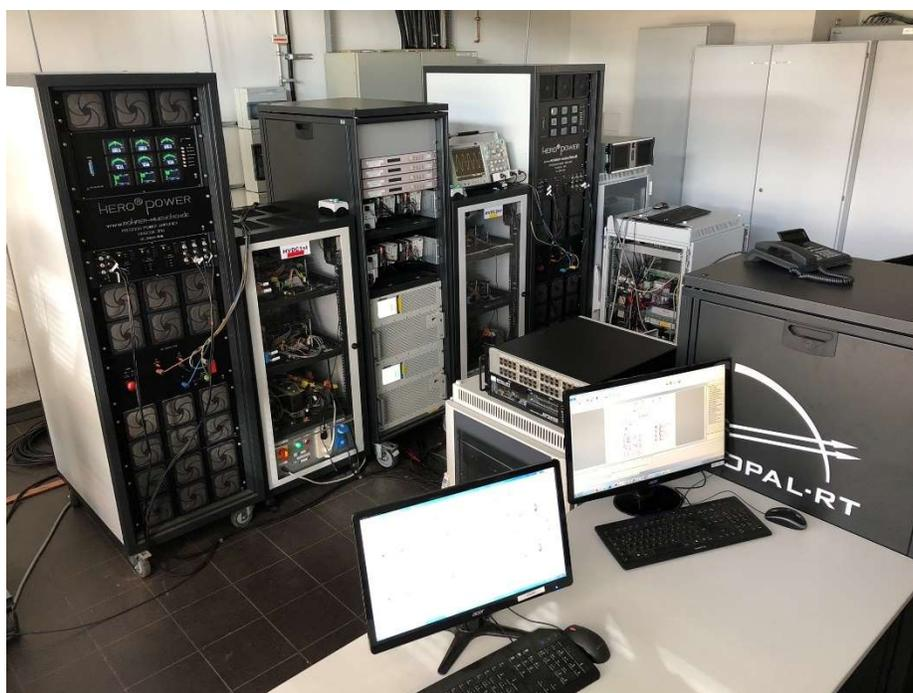
Abbildung 2-117 Netzsimulator im Labor
