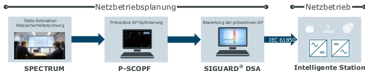
Abbildung 2-84 Umsetzung der präventiven Optimierung im Leitwartendemonstrator
