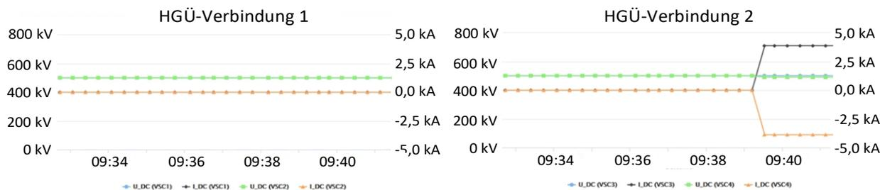
Abbildung 2-129 Verlauf von DC-Strom und DC-Spannung bei Aktivierung kurativer Arbeitspunkte
