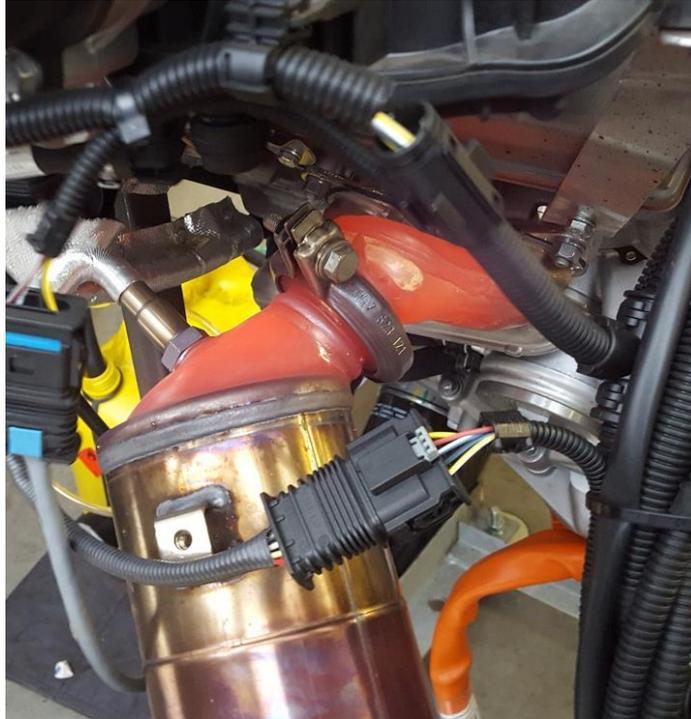
Abbildung 26 Rotglühender Abgaskrümmer des BMW i3 REX bei der Inbetriebnahme auf Grund reduzierter Motorsteuerung. © car systems Scheil
