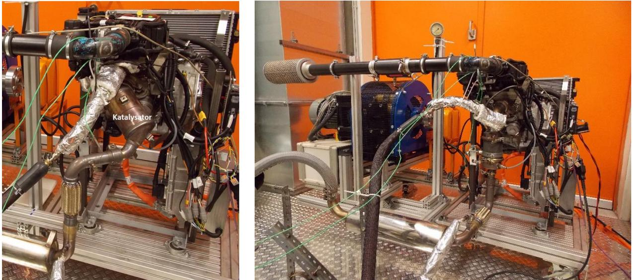
Abbildung 31 Im Projekt realisierter Prüfstands-aufbau des REX-Systems. © Argomotive
