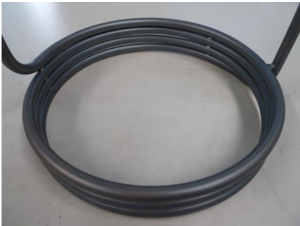
Abb.23: Kühlspirale nach anschließender Oxidation
