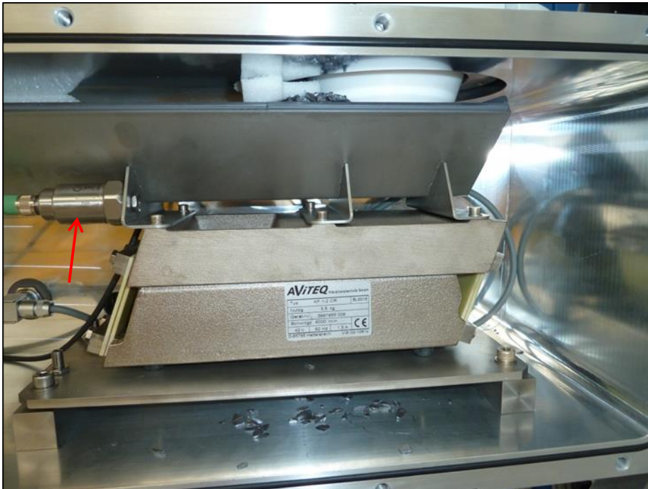
Abb.89: Beschleunigungssensor (Pfeil) in Schwingungsrichtung montiert.
