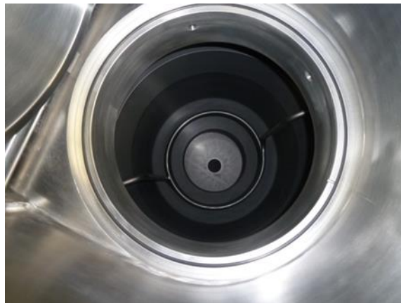
Abb.112: 26-Zoll Heizeinrichtung mit AKK
