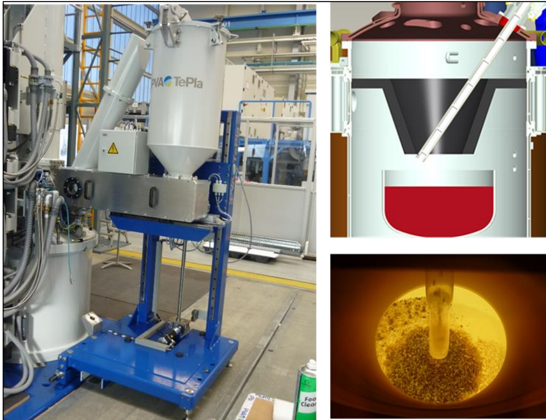
Abb.80: Mobiler Feeder an Kristallziehanlage angedockt (links) und mit in den Prozessraum eingefahrenen Quarzrohr (rechts oben: schematisch, rechts unten: während des Nachförderns).
