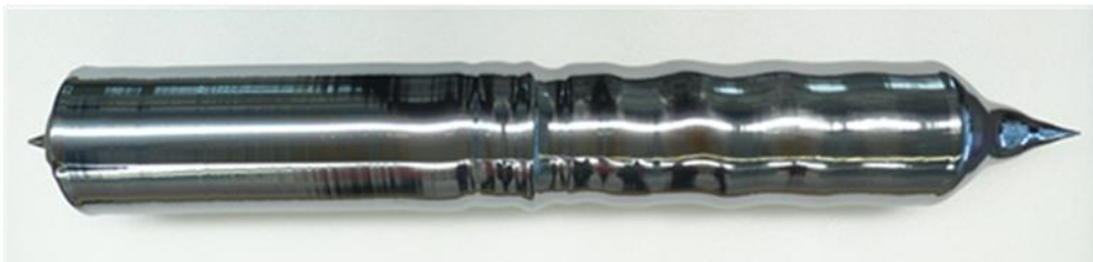
Abb.6: Kristall mit Formverlust in der Mitte des Stabes
