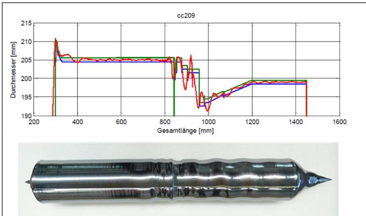
Abb.16: Züchtungsexperiment zur Ermittlung der maximalen Ziehbarkeit. In der Grafik ist der vom Datenerfassungssystem aufgezeichnete aktuelle Durchmesser (rote Kurve) dargestellt. Der Durchmesserverlust und das Spiralwachstum sind deutlich zu erkennen.
