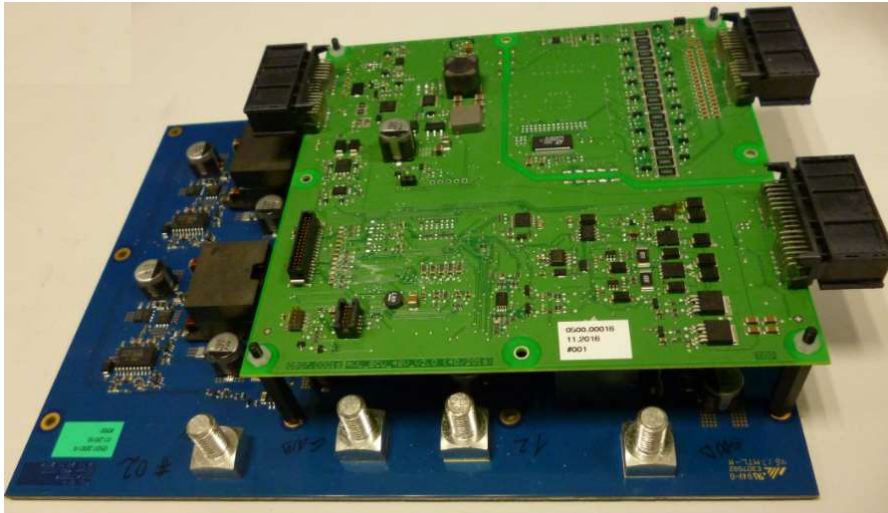
Abbildung 9: DC/DC-Wandler (blau) mit Control Unit (grün)
