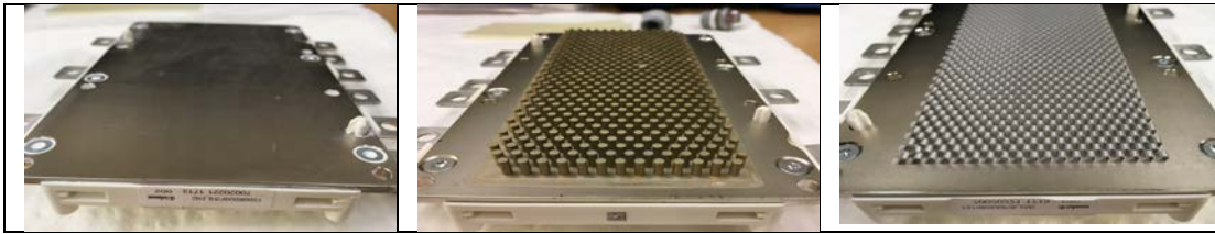
Abbildung 2 Bodenplatten mit Kühlstrukturen (links: plan; mittig: PinFin-Struktur; rechts: Bändchenbond)
