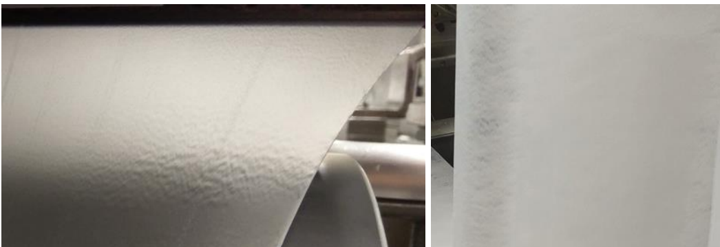
Abbildung 7 - Schmelzebruch bei der Verarbeitung von PE mit Molekulargewicht > 1Mio. g/mol.
