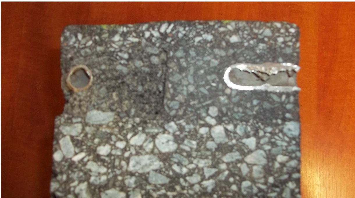
Bild 10: Entnommene Materialprobe als Schnitt mit Wärmeübertragerrbögen
