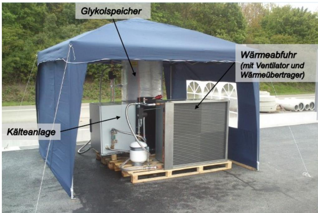
Bild 20: Montage Rückkühleinheit im duraBAST Gelände am 26. April 2017
