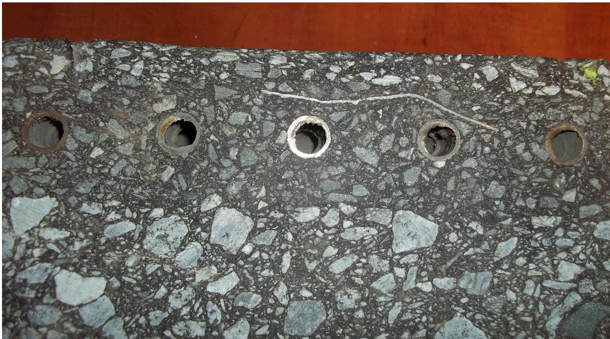
Bild 8: Entnommene Materialprobe als Schnitt mit Wärmeübertragerrohren
