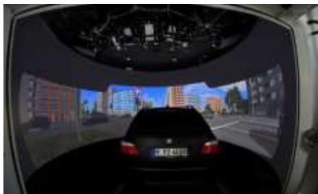
Abbildung 65: Dynamischer Simulator der BMW AG
