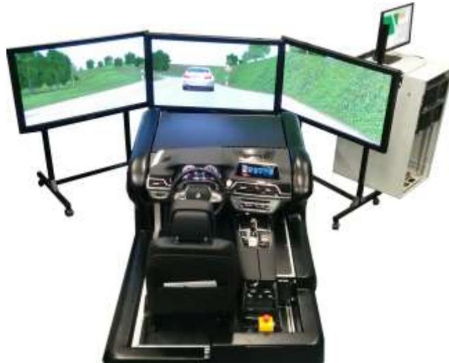
**Abbildung 81:** Mockup als Grundlage der virtuellen Erprobung
