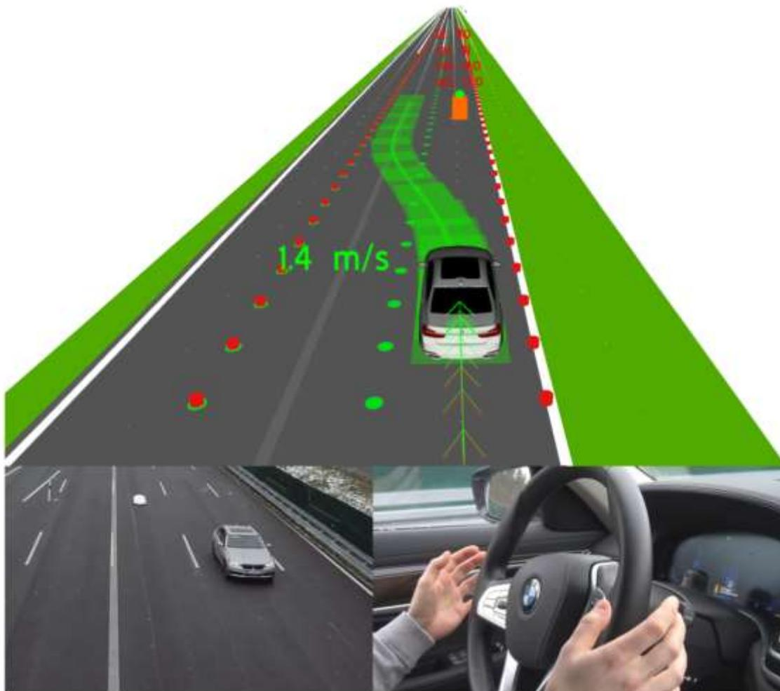
**Abbildung 9:** Darstellung der statischen Umfeldmodelldaten inklusive des Hindernisses, dazu Außenansicht und Visualisierung für den Fahrer
