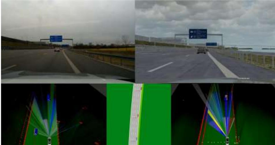
**Abbildung 85:** Visualisierung einer realen und virtuell nachgestellten Fahrt mit entsprechenden Sensor- und Fusionsergebnissen
