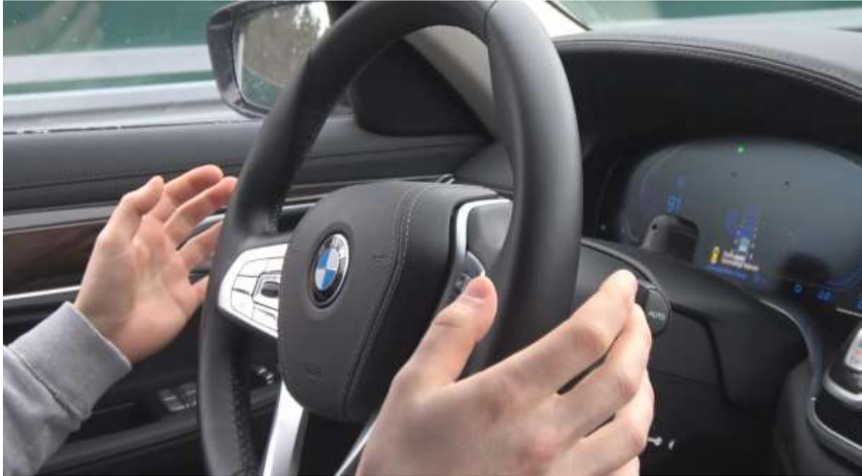
**Abbildung 77:** Automatisierter Spurwechsel mit Visualisierung
