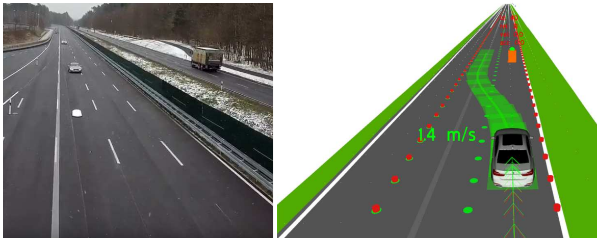
Abbildung 6: Das im Rahmen der Ko-HAF Abschlusspräsentation von Audi und BMW gemeinsam gezeigte Skibox-Szenario aus Vogelperspektive (Abbildung links). Hierbei wird das nachfolgende Fahrzeug (BMW) durch das Vorderfahrzeug (Audi) hinsichtlich der auf der Fahrbahn liegenden Skibox gewarnt. Die Gefahrenstelle wird im Rahmen der Trajektorienplanung der HAF-Funktion vorausschauend berücksichtigt (Abbildung rechts).
