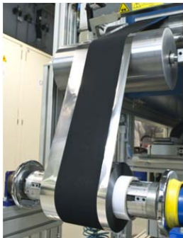
Abbildung 38 Foto aus der R2R-Kathodenherstellung für SepaLiS-Prototypzellen
