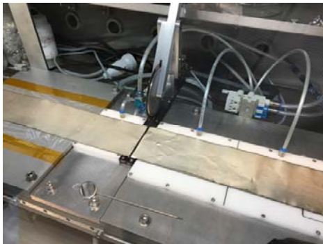
Abbildung 74 Foto der Anlage zum Schneiden von Li (integriert in Glovebox)
