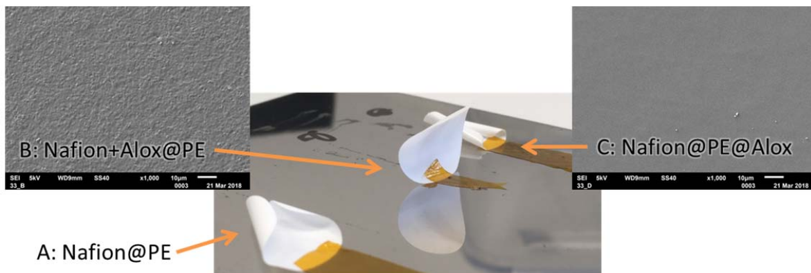
Abbildung 54 beschichtete BM PE-Separatoren mit Nafion und Nafion/Alox Schichten.
