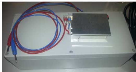
Abbildung 14: Werkzeug zum Einschweißen von Elektroden in Separatortaschen.
