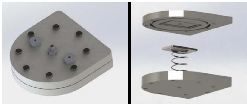
Abbildung 15: Messzelle aus Edelstahl mit beidseitigen Adaptern zum Massenspektrometer (MS) für die Untersuchung jedes Elektrodenraums bei Einsatz eines dichten Separators.
