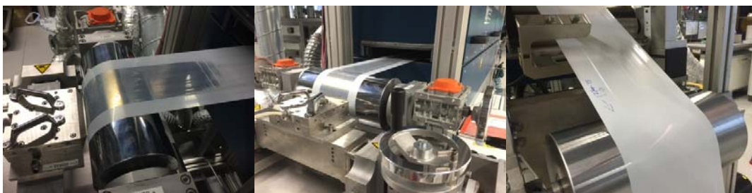
Abbildung 45 Beschichtung des von BM zur Verfügung gestellten HDPE Separators (15 \mu\text{m} ) mit einer Nafion®-Beschichtung im R2R-Verfahren mittels Schlitzdüsenauftrag.
