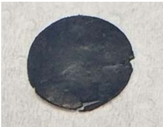
Abbildung 29 a) Solid-State-Schwefelkathode mit d=10 mm und b) Lade- und Entladekurven einer Li-S Solid-State-Zelle bei 80 °C
