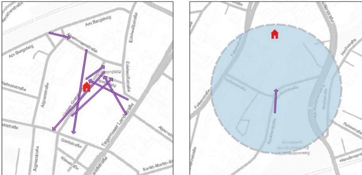
Abbildung 57: Generierung der Home-Position (rotes Symbol) falls mehrere Fahrten von einem Nutzer durchgeführt wurden (links) oder falls nur eine Fahrt durchgeführt wurde (rechts). Die Pfeile in lila zeigen von dem Start-Punkt einer Buchung zu dem End-Punkt der Buchung
