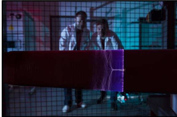
Abbildung 1: Teilentladungen zerstören polymere und kohlenstoffhaltige Isolationskomponenten. – Quelle: Siemens AG
