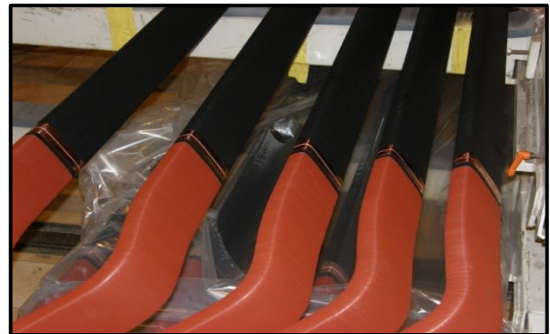
Abbildung 2: Generatorstäbe mit einem schwarzen, kohlenstoffhaltigen Außenglimmschutz – Quelle: Siemens AG
