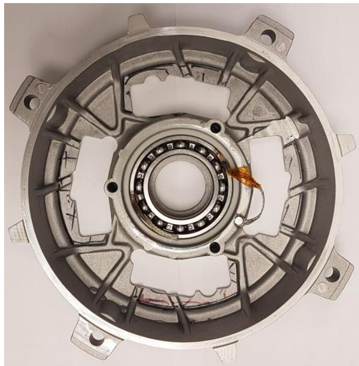
Abbildung 32: Testmaschine 2: Isoliertes Lager mit 4 Speichen zur Messung von Lagerströmen
