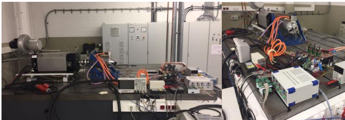
Abbildung 77: Prüfstands Aufbau des Si 1200 V Umrichters
