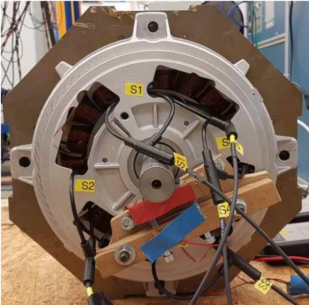
Abbildung 33: Testmaschine 2 mit isoliertem Lager und 4 Speichen zur Messung von Lagerströmen
