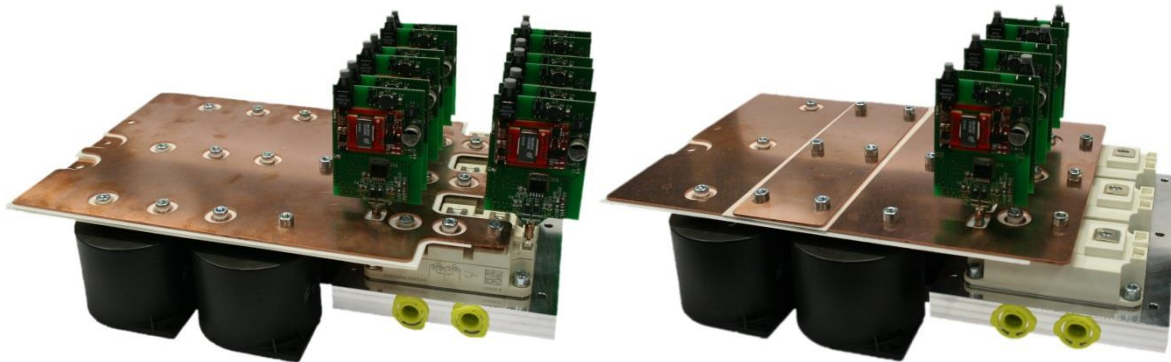
Abbildung 75: NPC- (links) und B6C-Umrichter (rechts)
