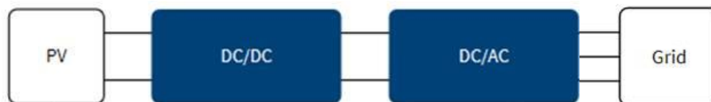
Abbildung 3: Topologie Zentralinverter für Photovoltaik
