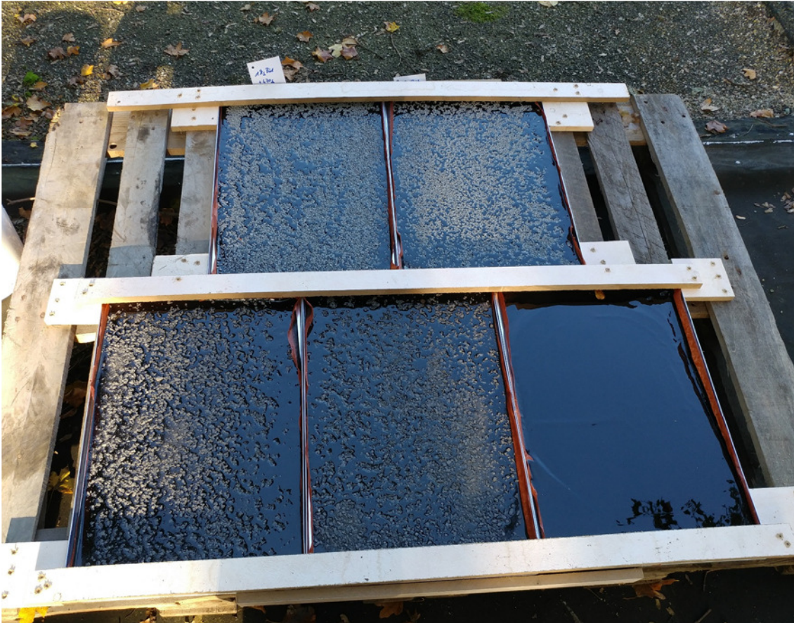
Abbildung 10: Bewitterungsstand mit abgestreutem Bitumen in einer Schichtdicke von 0,41 mm inkl. Referenzblech ohne Abstreuerung
