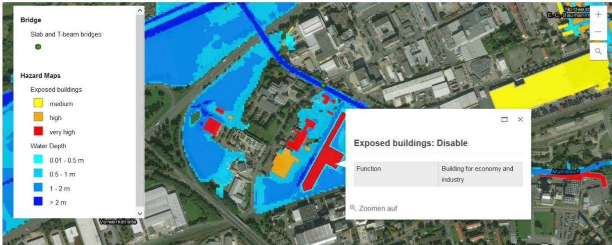
Abb. 9: Risikokarten –automatische Ermittlung exponierter Bauwerke
