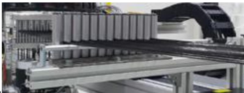
Abbildung 5-11: Faserführung Schussfadenversatz
