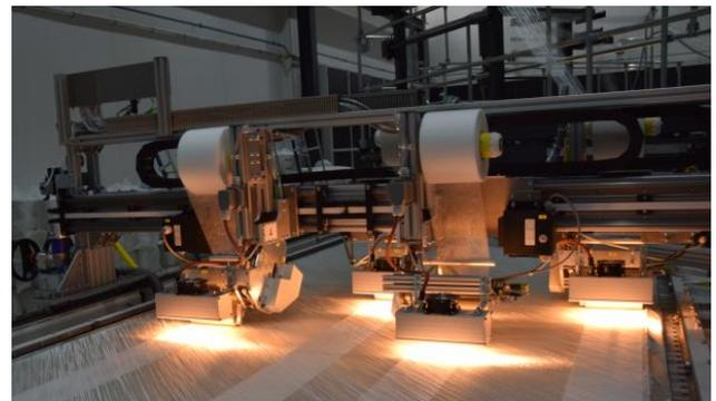
Abbildung 5-18: Spunfab-Zuführungen und IR-Strahler
