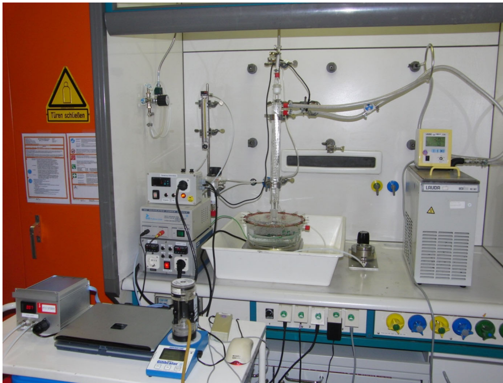
Abbildung 4: Alter Aufbau für die künstliche GDL Alterung. Mitte: Glasreaktor mit Probe in 35 %-iger H_2O_2 -Lösung bei 90 °C und Glaskühler. Rechts: Kryothermostat bei 5 °C. Links: Temperaturregelung, CO_2 -Sensor und Volumenstrommessung. Rechts: Druckminderer für N_2 und Kühlthermostat.
