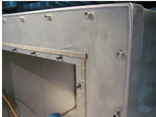
Abbildung 7-14: Abdichtung des Messfensters mit einer EMV-Flachdichtung (Hersteller- Hollandshielding)
