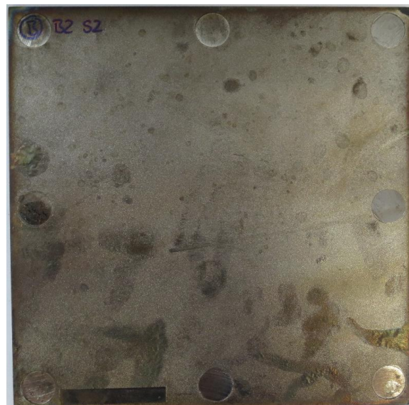
Abbildung 7-30: Optische Inspektion der Beschichtungen nach 20 Zyklen
