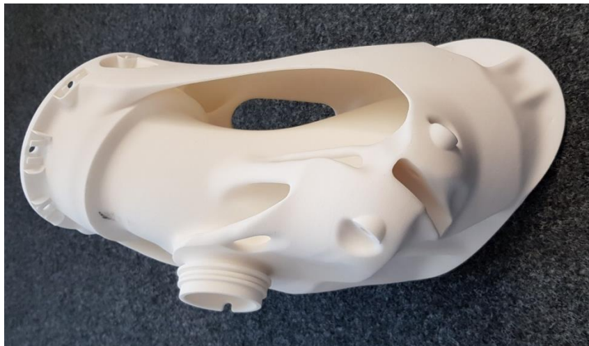
Abbildung 7-7: Drainage Bogen nach Optimierung
