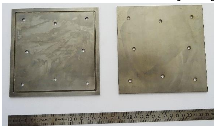
Abbildung 7-36: Metallische Prüfplatten zum Testen von EMV-Dichtungen
