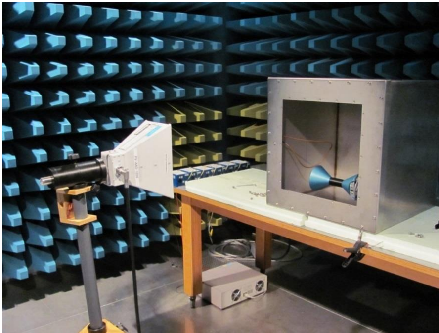
Abbildung 7-13: Messaufbau zur Untersuchung der Schirmdämpfung
