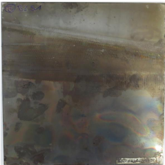
Abbildung 7-30: Optische Inspektion der Beschichtungen nach 20 Zyklen
