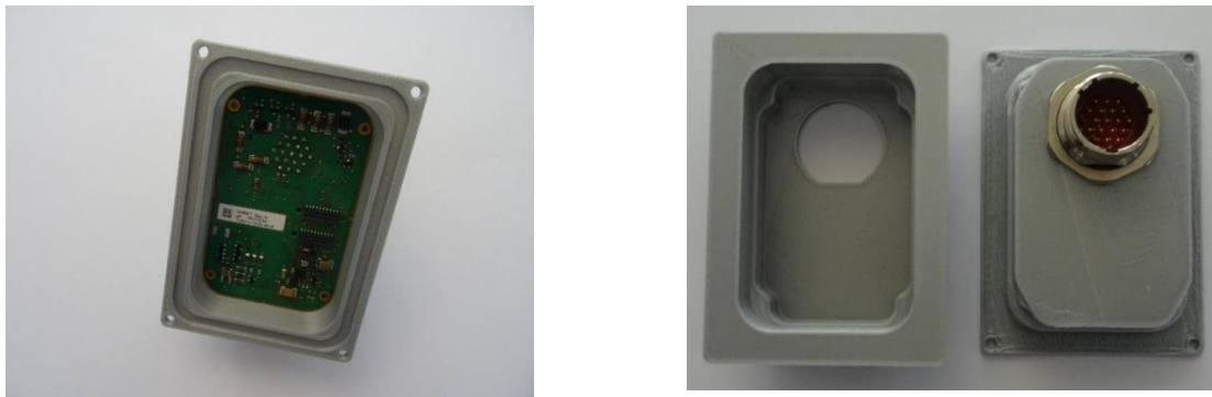
Abbildung 7-37: Im 3D-Druck gefertigtes Konstruktionsmuster
