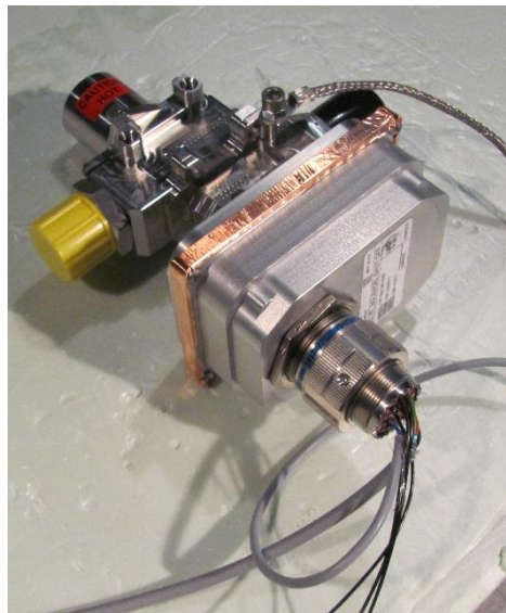
Abbildung 7-19: Magnetventil mit Aluminium-Gehäuse und mit Kupferklebeband abgedichtetem Spalt
