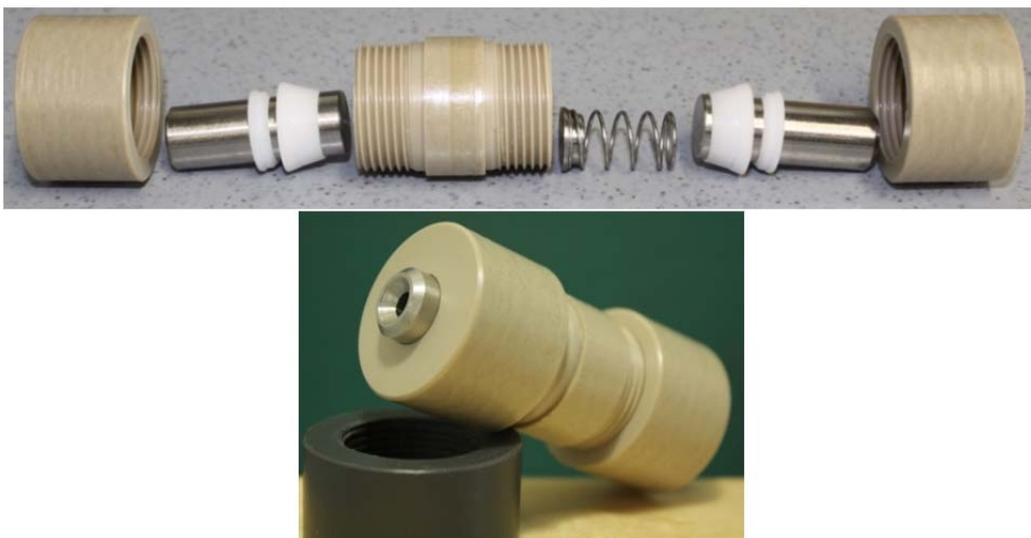
*Abbildung 15: Für I-Zellen-Tests verwendete PEEK-Zelle, als Explosionsbild (oben) und zur Messzelle dicht verschraubt (unten).*
