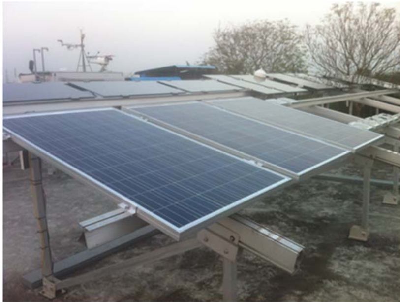
Abb. 8. Prüfungsstandort Indien. Die drei Testmodule und die sieben Lamine zur Untersuchung der Wirkung von Messing und Zink auf die Entwicklung von biologischem Soiling auf PV Modulen sind auf der ersten Reihe zu sehen.
