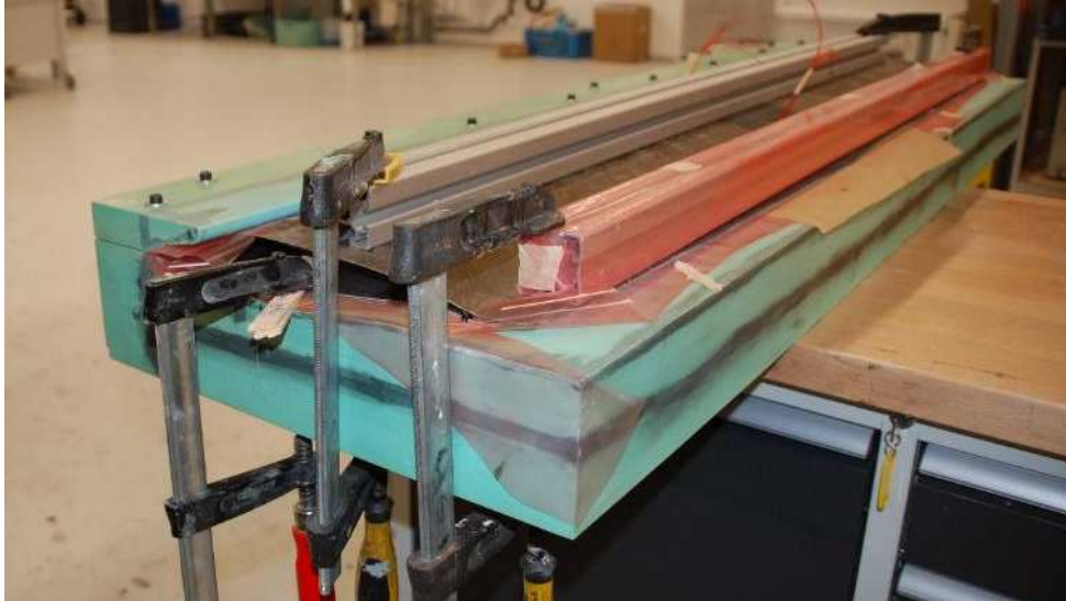
Abbildung 53: Das Verkleben der unteren und oberen Halbschalen mit dem U-Schubfeldträgers in der Laminierform
