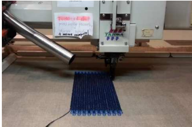
Abbildung 47: Herstellung eines flächigen TFP-Halbzeuges durch Besticken von Flaxply BD 150 mit 12k CF-Roving für nachträgliche Herstellung von Zugproben
