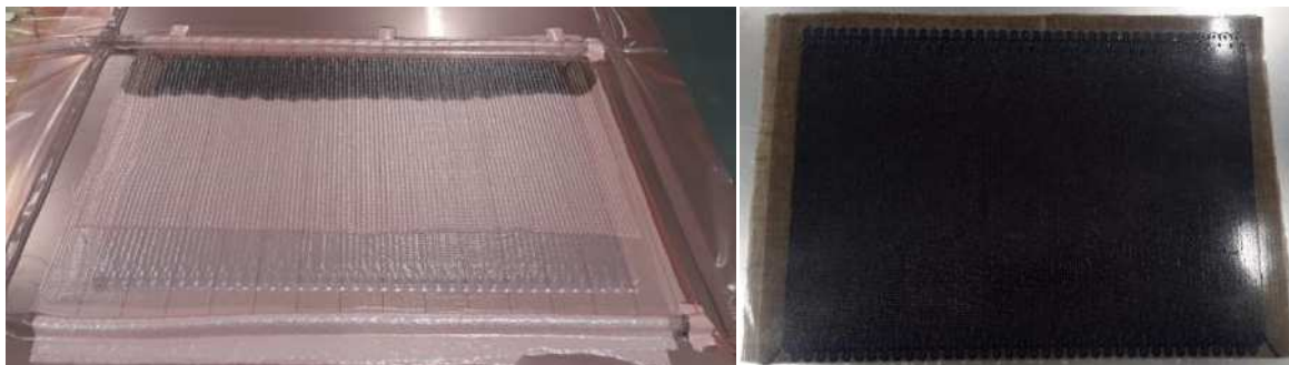
Abbildung 46: Herstellung von Zugproben aus TFP-Halbzeug mittels Vakuuminfusionsverfahren (links), Konsolidierte TFP-CF/Flachs-Platte
