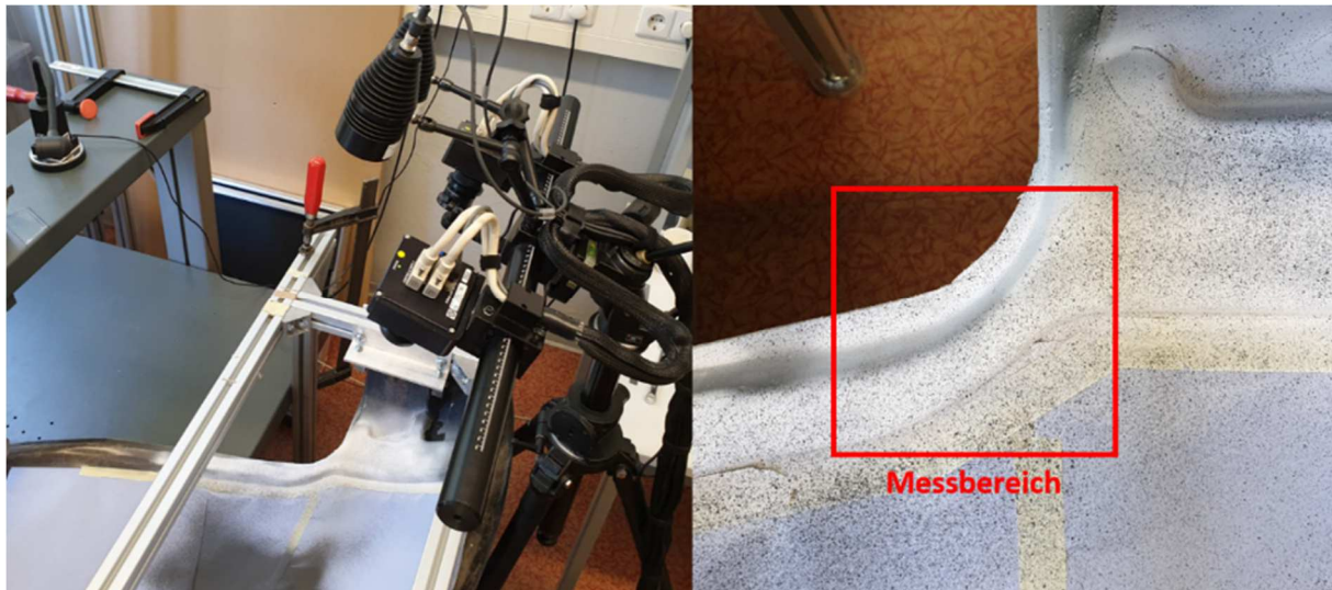
Abbildung 71: Erfassung der Oberflächenverschiebungen mit einem optischen Messsystem ARAMIS
