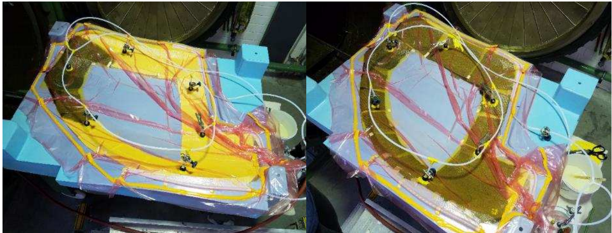
Abbildung 57: Der Infiltrationsvorgang der Außenschale mit sichtbarer Fließfront (links: Anfang, rechts: Ende des Infiltrationsvorganges)
