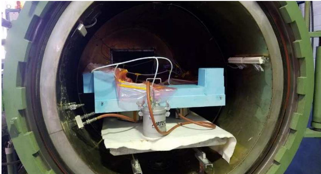
Abbildung 58: Die infiltrierte Außenschale im Autoklaven
