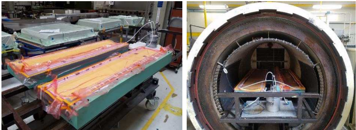
Abbildung 49: Fertigung der HLW-Hälften mittels VARI-Verfahren (links) und anschließender Aushärtung im Autoklaven (rechts)
