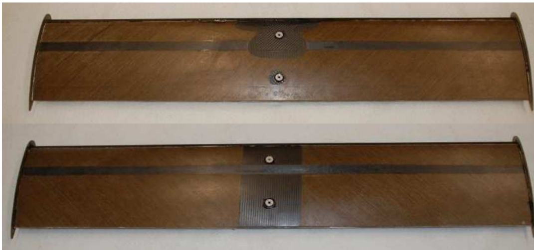
Abbildung 54: Fertige Höhenleitwerke (oben: Variante 1 mit U-Schubfeldträger, unten: Variante 2 mit topologieoptimiertem Kern)
