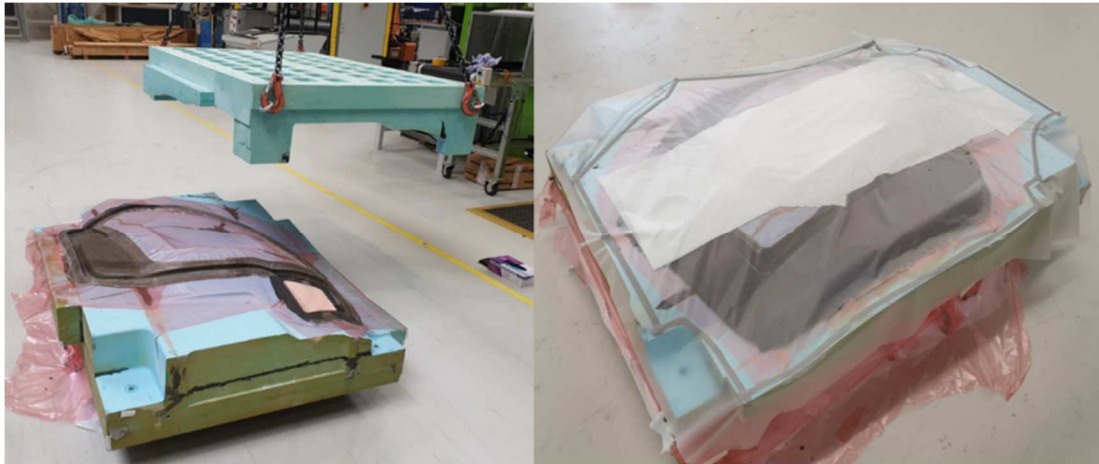
Abbildung 61: Verklebung der einzelnen Schalen in der Laminierform (links), Verklebung der bearbeiteten Tür mit der Fensterscheibe unter ungelegtem Vakuum
