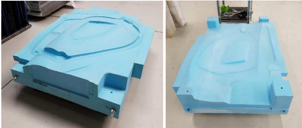
Abbildung 56: Laminierformen (links: Innenseite, rechts: Außenseite) für die Herstellung der Kabinentür
