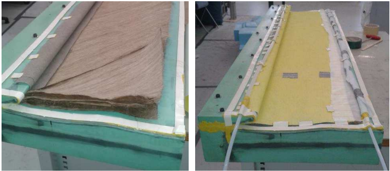
Abbildung 50: Textiler Aufbau der unteren Hälfte des HLW (links) sowie fertiger Aufbau für das VARI-Verfahren (rechts)
