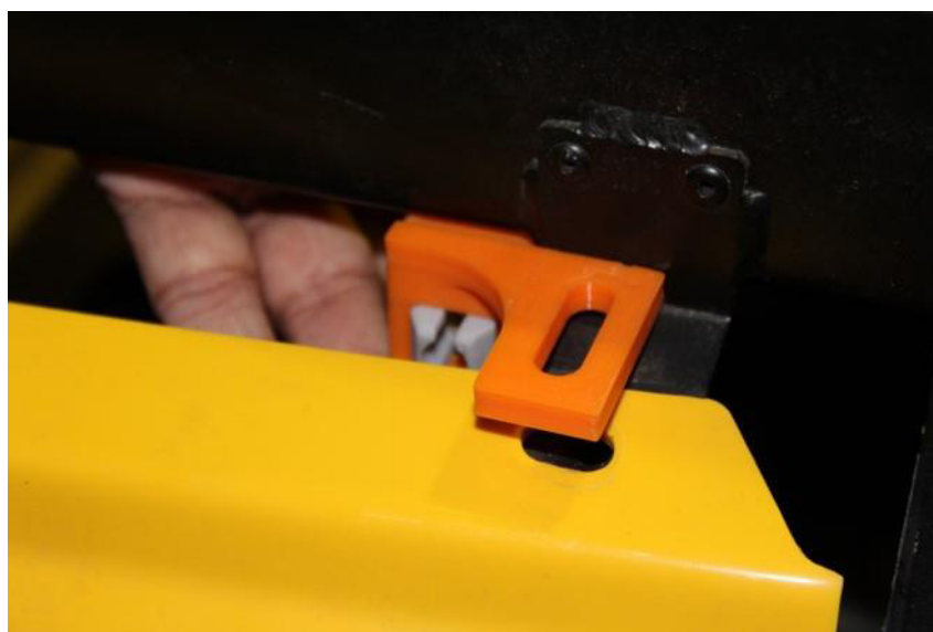
Abbildung 22 3D-gedruckter Baustein am Demonstrator 2
