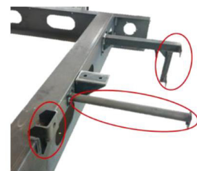
Abbildung 4 Karosserie-Bauweisen: Schalenbauweise 9 (links) und Spaceframe (mitte) 10 , Beispiel für Anbindungspunkte rechts (Heckrahmen Karosserie StreetScooter)
