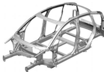
Abbildung 4 Karosserie-Bauweisen: Schalenbauweise 9 (links) und Spaceframe (mitte) 10 , Beispiel für Anbindungspunkte rechts (Heckrahmen Karosserie StreetScooter)
