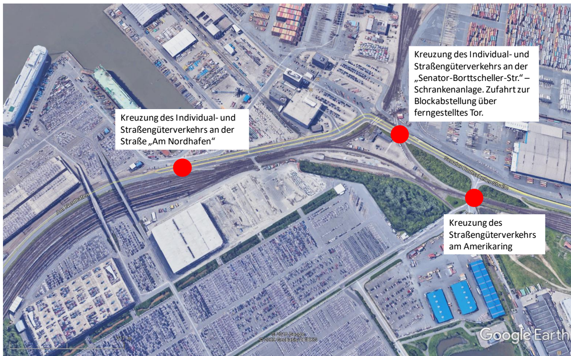
Abbildung 89 Beispiele für systemexterne Einflüsse, welche einen automatisierten Rangierbetrieb erschweren.
