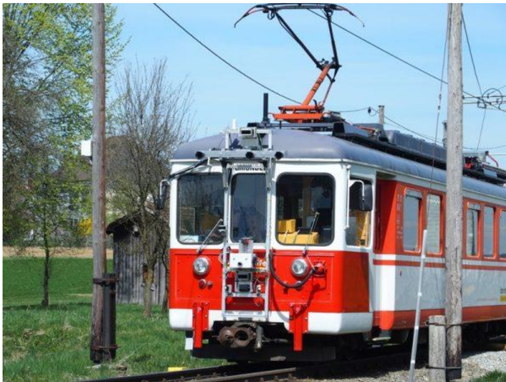
Abbildung 20 Testzug des Forschungsprojektes „autoBAHN“ mit Kameras, Radar und Lidar
