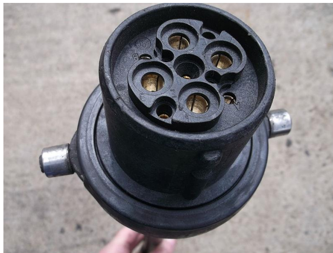
Abbildung 14 Neunpoliger UIC-Leitungsstecker der Deutschen Bahn
