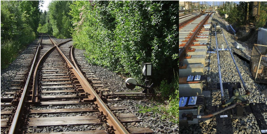
Abbildung 25 Ortsgestellte Weiche mit Stellbock und Weichensignal (links), Übertragungsteile einer ferngestellten Weiche (rechts)
