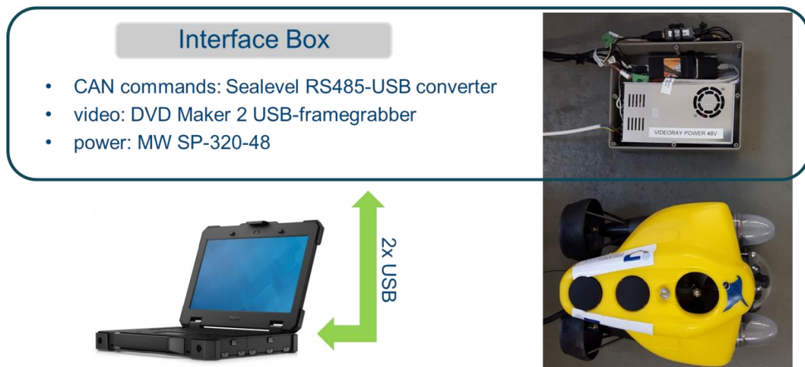
Abbildung 5: Interface Box zwischen Bediener-Laptop und Vehicle
