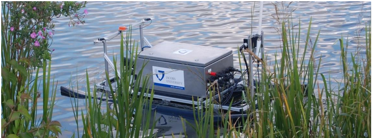
Abbildung 6: Das Unmanned Surface Vehicle (USV) "Muddy Waters II" als Trägerplattform.
