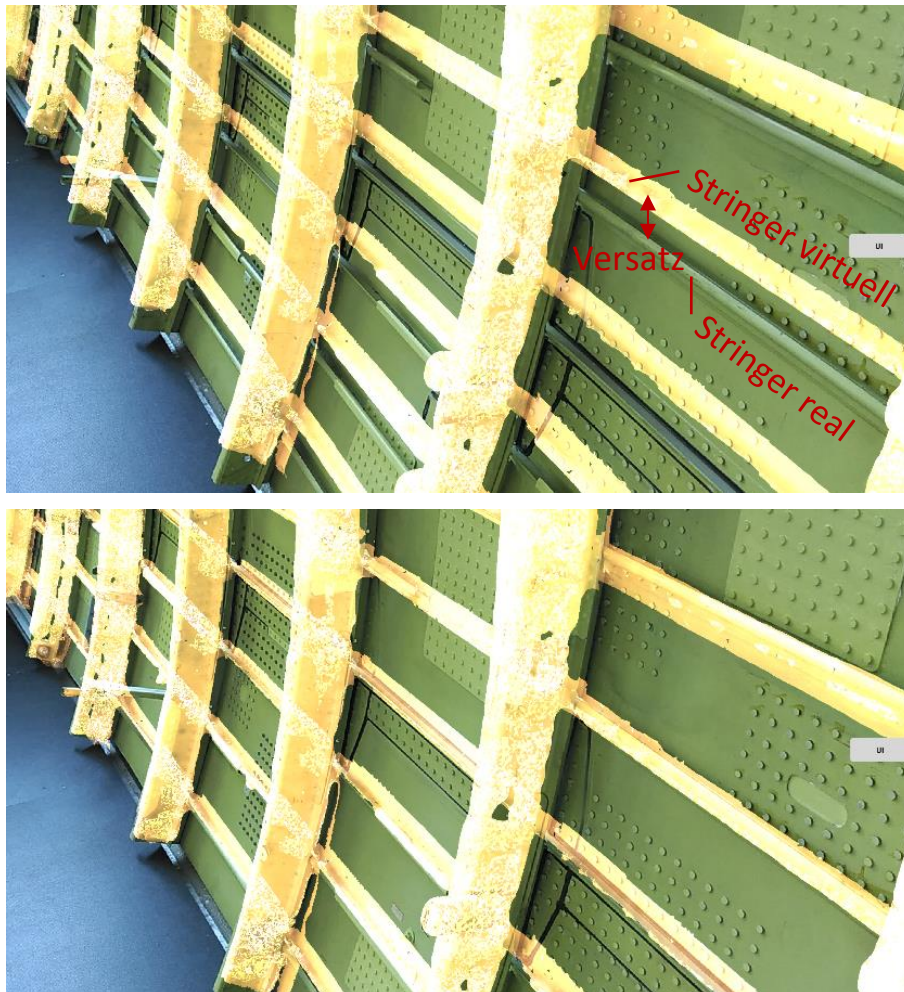
Bild 2-22: Referenzmodell nach der Grobpositionierung (oben) und nach der Feinpositionierung (unten)
