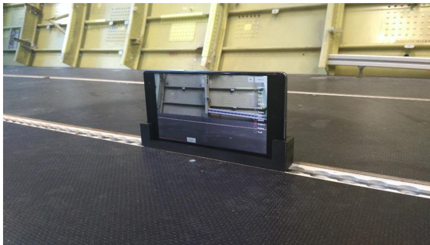
Bild 2-21: Halterung zur schnellen Wieder-Einmessung (Grobeinmessung) des AR-Digitalisierungssystems
