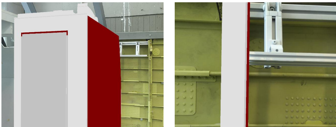
Bild 2-25: AR-Visualisierung eines Kabinenelements in der Umgebung
