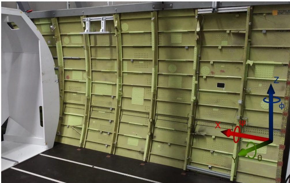
Bild 2-17: Ausrichtung der Koordinatenachsen des Flugzeugkoordinatensystems
