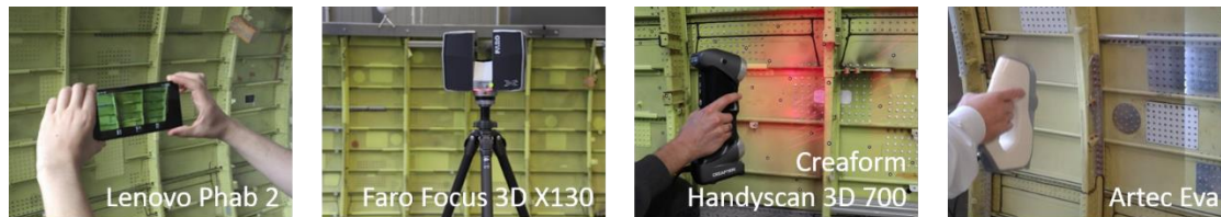
Bild 2-37: Untersuchte 3D Scanner [Den19]
