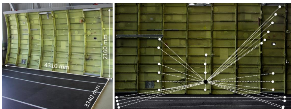
Bild 2-36: TUHH Kabinendemonstrator mit Angabe des Messvolumens sowie verwendete Messpunkte für die Genauigkeitsuntersuchung [Den19]
