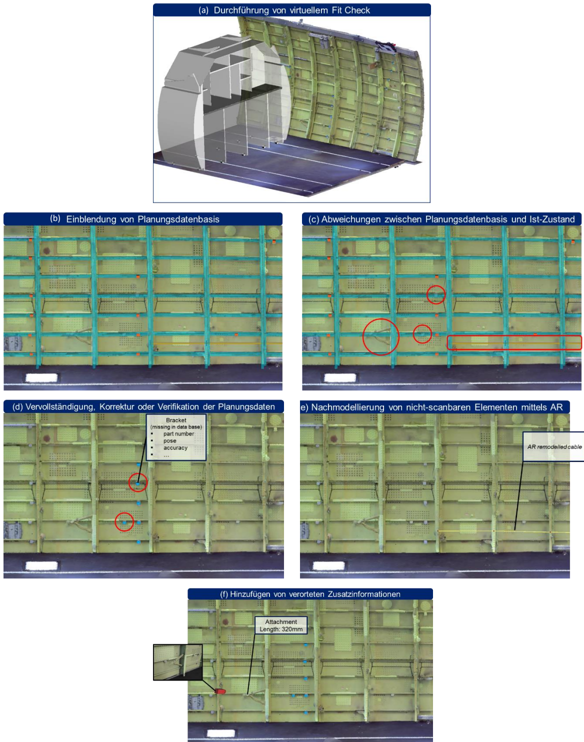
Bild 2-9: Visualisierung des Augmented Reality-Konzeptes
